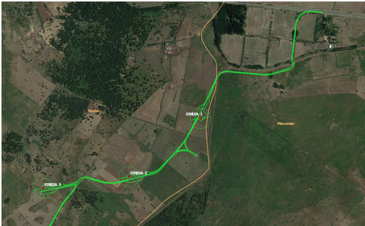
Figura 1: Inquadramento territoriale su base satellitare del layout di impianto (in verde) - in figura sono illustrate gli aerogeneratori (pallini rossi) SINDIA 1, SINDIA 2, SINDIA 3, e i relativi cavidotti di connessione
