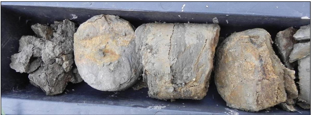
FIGURA 4.3 – Marne alterate attraversate da apparati radicali estratte da un sondaggio presso la frazione di
