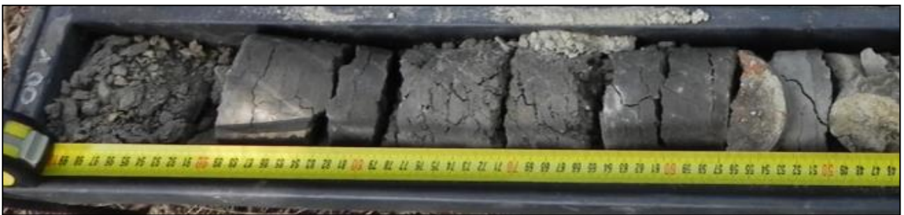
FIGURA 4.1 – Argille limose bruno-grigiastre provenienti da sondaggio presso la frazione di Seuni. Argille limose di colore grigio-brunastro, plastiche, poco consistenti e localmente presenti in coincidenza delle aree depresse o di pedimonte, in lingue o lenti senza soluzione di continuità.
