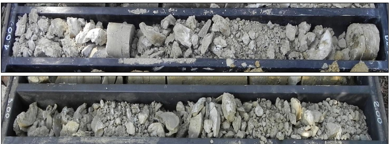
FIGURA 4.2 – Colluvi argilloso-limosi da alcuni sondaggi in agro presso la frazione di Seuni.
