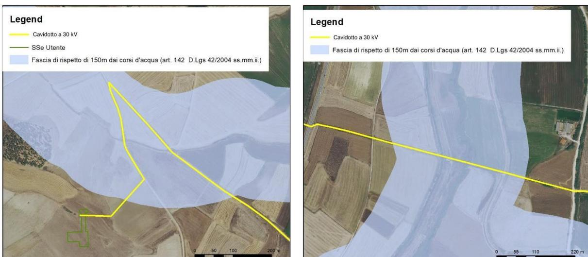
Figura 9.1 - Sovrapposizione del cavidotto 30 kV ivi impostato quasi totalmente su viabilità esistente con la fascia di tutela paesaggistica di 150m del fiume "Riu Sassuni" (a sinistra) e "Flumini Mannu" (a destra)
