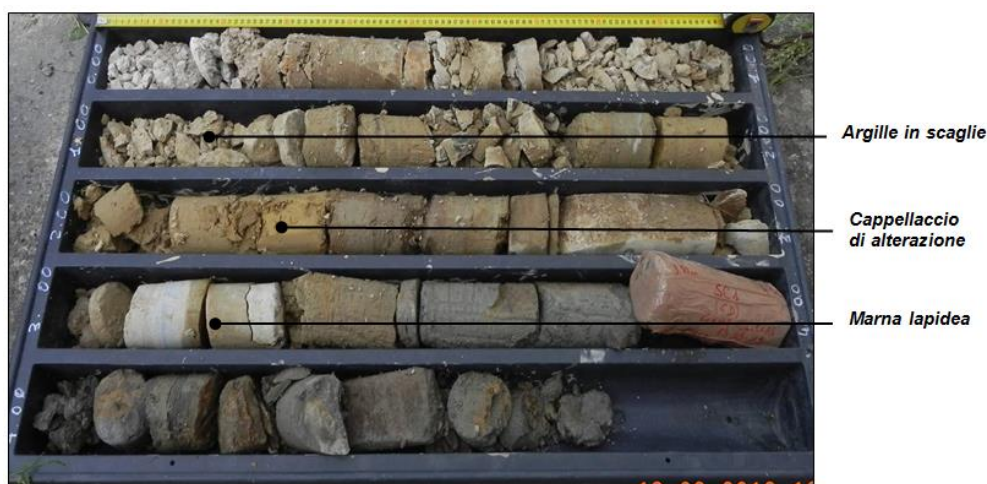
Figura 3.5 – Terreni estratti da un sondaggio realizzato presso l'abitato di Seuni.
