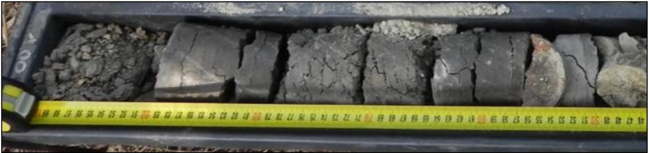
FIGURA 2.4 – Argille limose bruno-grigiastre provenienti da sondaggio presso la frazione di Seuni. Argille limose di colore grigio-brunastro, plastiche, poco consistenti e localmente presenti in coincidenza delle aree depresse o di pedimonte, in lingue o lenti senza soluzione di continuità.
