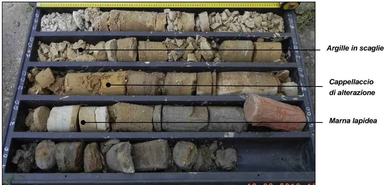
FIGURA 2.9 – Terreni estratti da un sondaggio realizzato presso l'abitato di Seuni.
