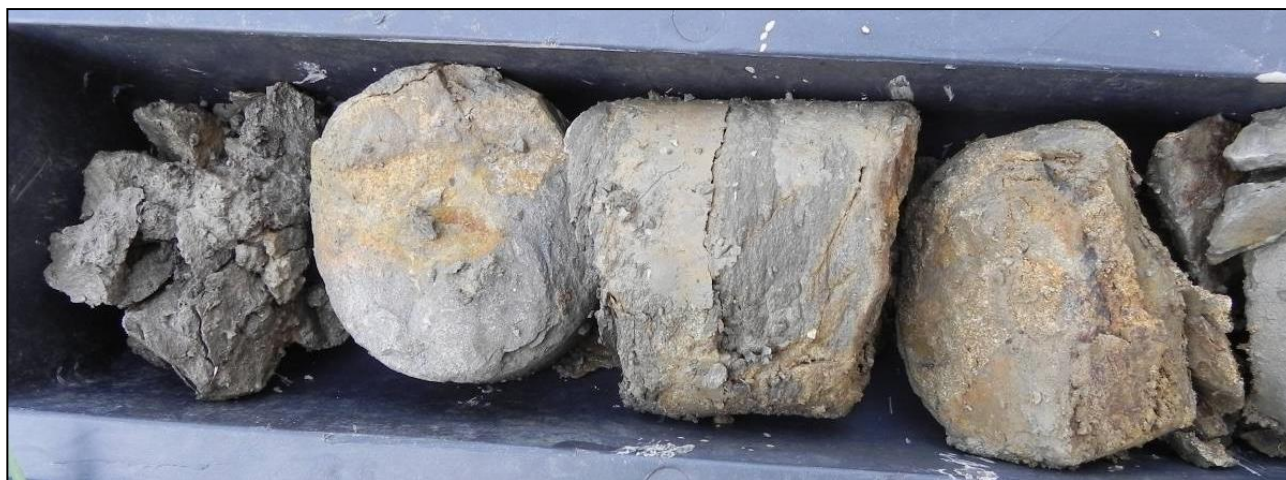
FIGURA 2.6 – Marne alterate attraversate da apparati radicali estratte da un sondaggio presso la frazione di
