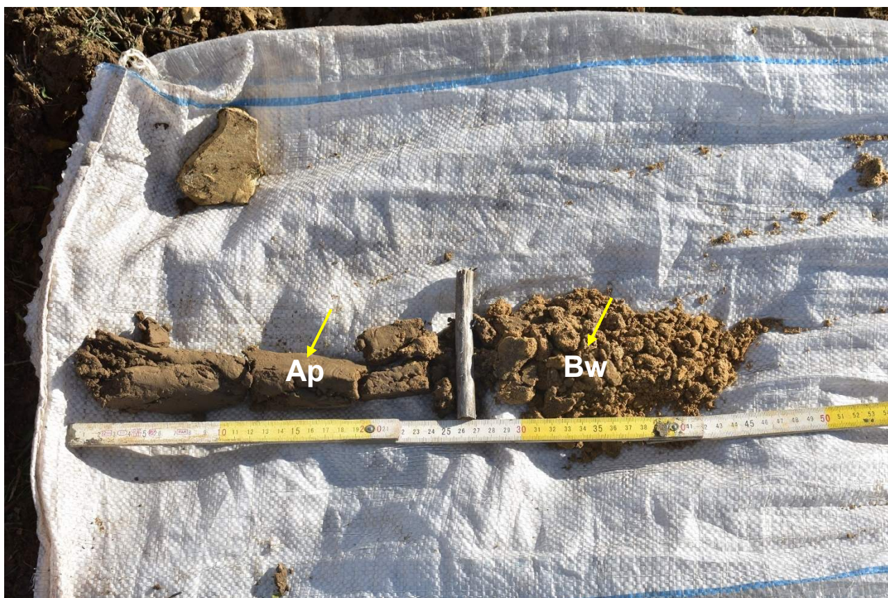
Figura 14 Dettaglio profilo Ap – Bw della sottostazione ottenuto mediante trivellata
