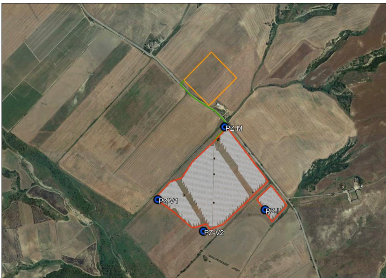
Figura 2 – Ubicazione piezometri previsti per monitoraggio acque sotterranee
