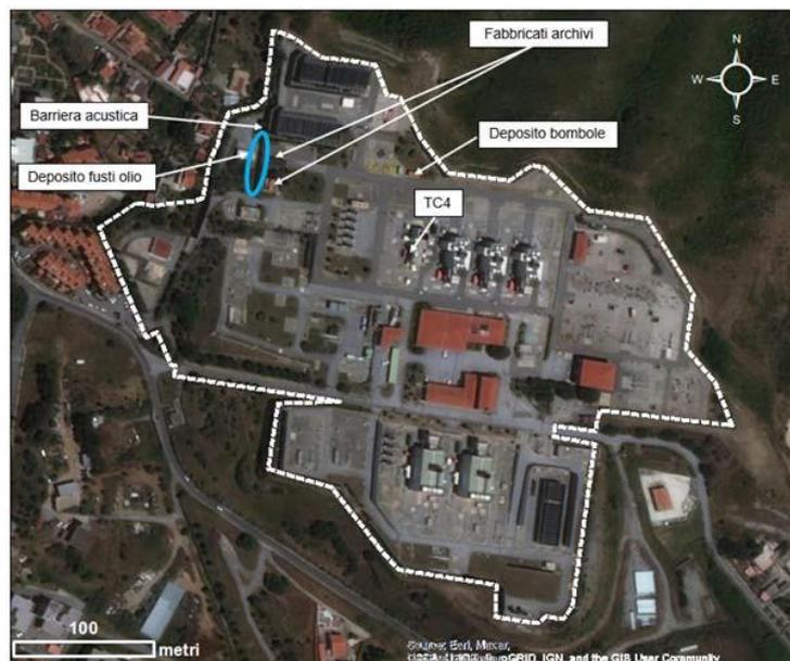
Figura 5 - Progetto di adeguamento impianto. Smantellamenti e demolizioni. Della barriera acustica verrà demolito solo il tratto cerchiato in azzurro
