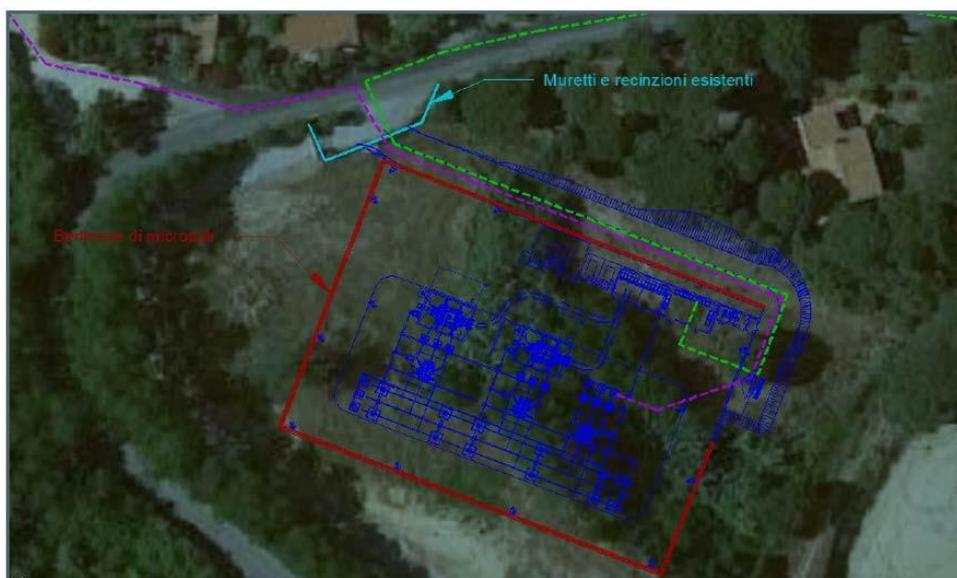
Figura 7 - Sottostazione Elettrica d'Utente. Opere in progetto (ciano = muretti e recinzioni da demolire; rosso = berlinese da realizzare; magenta = cavidotto AT; verde = cavidotto MT; all'interno apparecchiature elettromeccaniche ed edifici di stazione)
