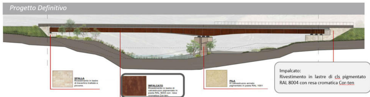
Figura 4-4 – Trattamento cromatico Viadotto Fluvione PD
