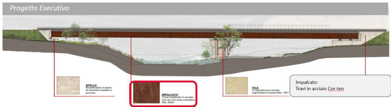
Figura 4-5 – Trattamento cromatico Viadotto Fluvione PE
