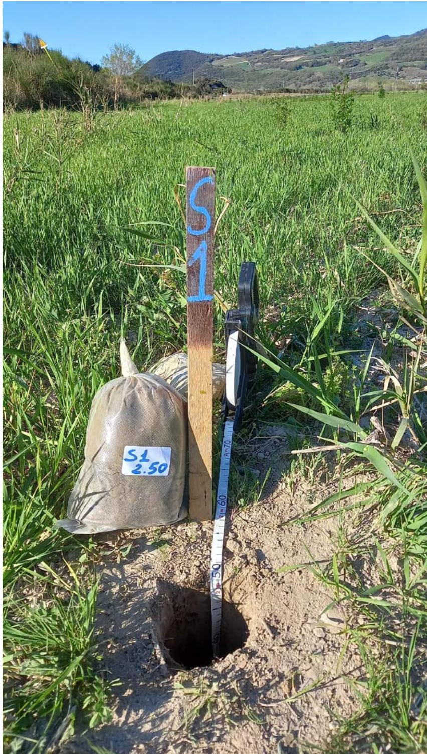
**Foto 2** – Punto di prelievo n. 1 – Saggio con campione a profondità di 2,50 m dal p.c.
