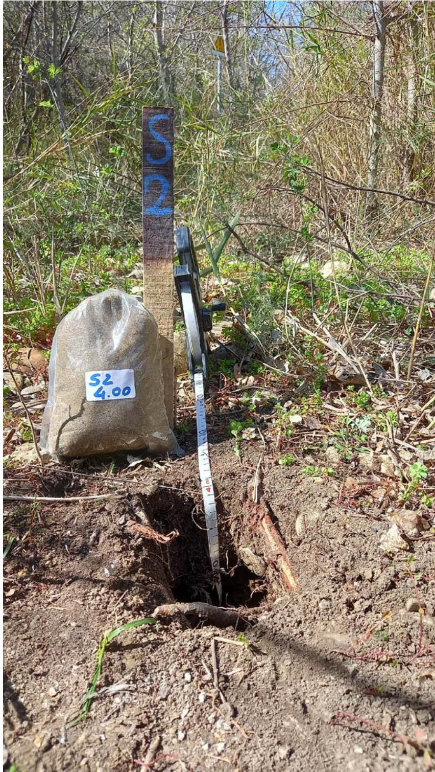
Foto 4 – Punto di prelievo n. 2 – Saggio con campione a profondità di 4,00 m dal p.c.
