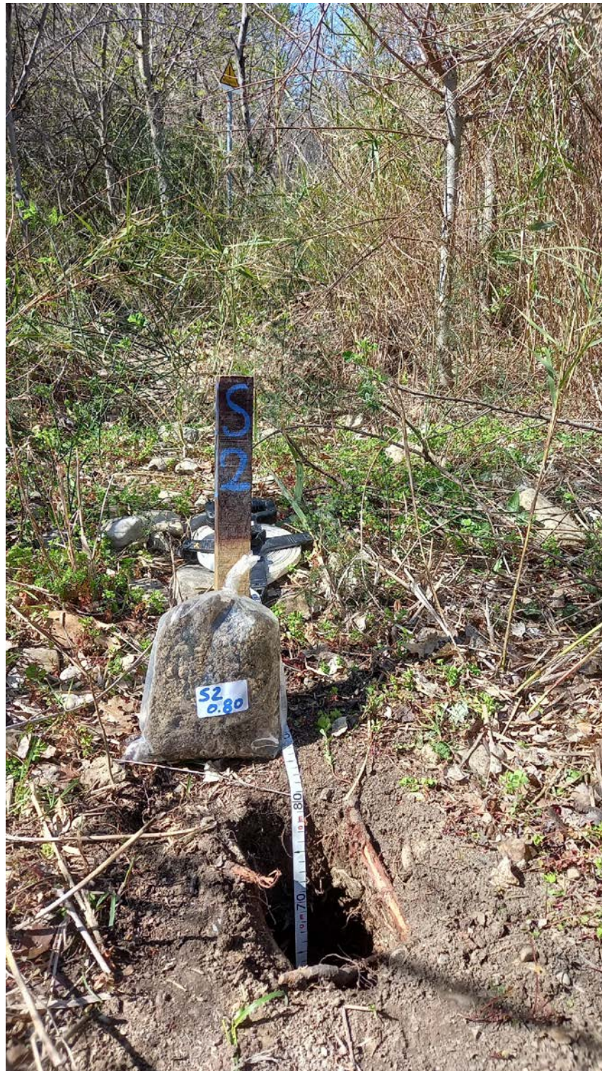
Foto 3 – Punto di indagine n. 2 – Saggio con campione a profondità di 0,80 m dal p.c.
