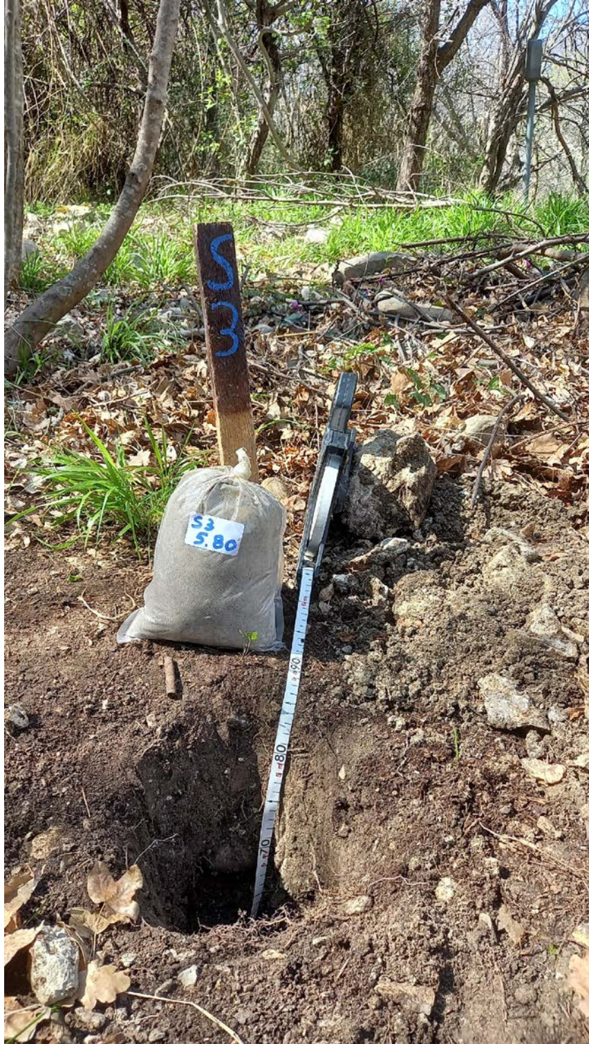
Foto 6 – Punto di prelievo n. 3 – Saggio con campione a profondità di 5,80 m dal p.c.
