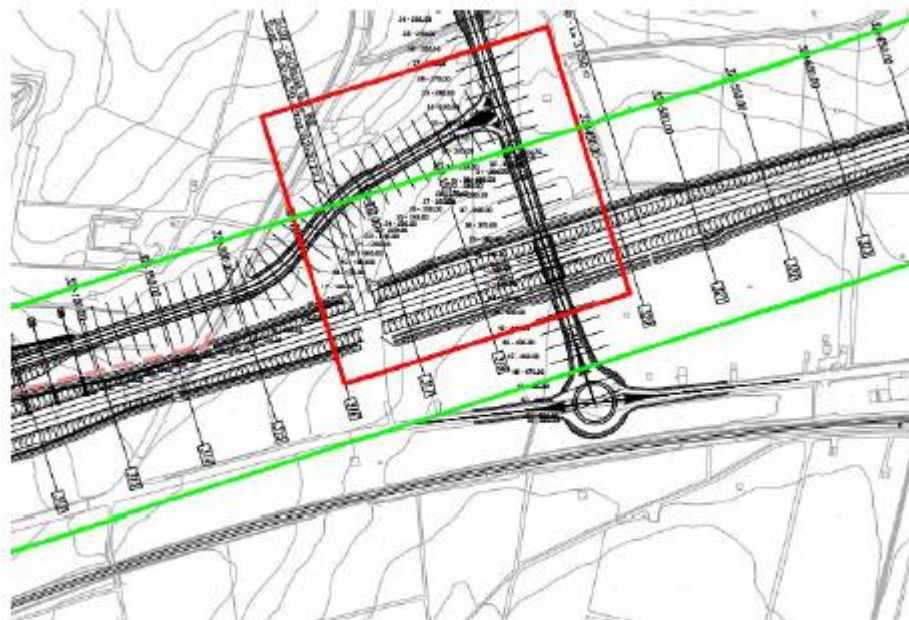
Figura 5: Traslazione verso est del sottovia SL07
