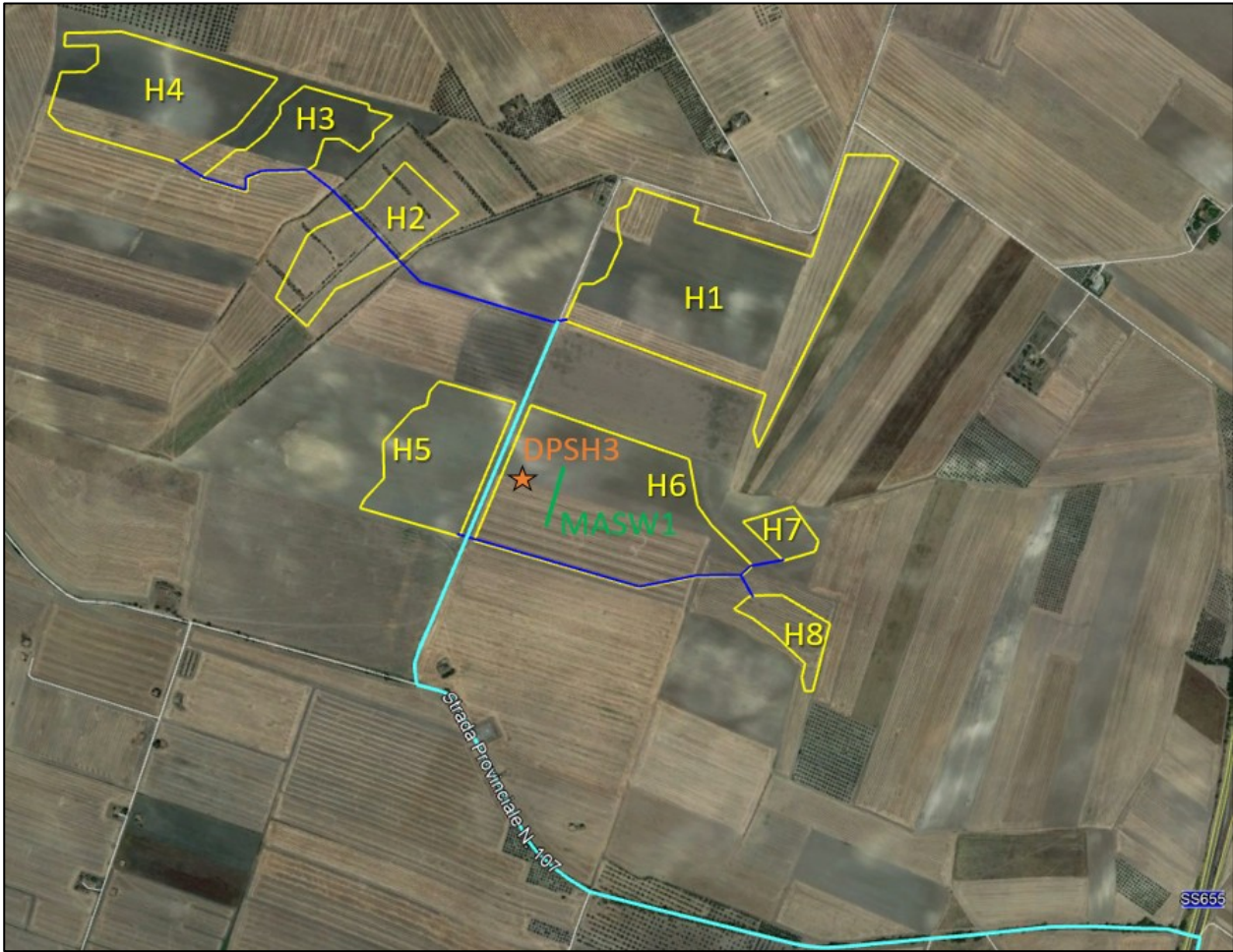
Figura 12 - Ubicazione delle indagini geotecniche (DPSH1, DPSH2 e DPSH3) e geofisiche (MASW1 e HVSR1) eseguite nei vari lotti di terreno.
