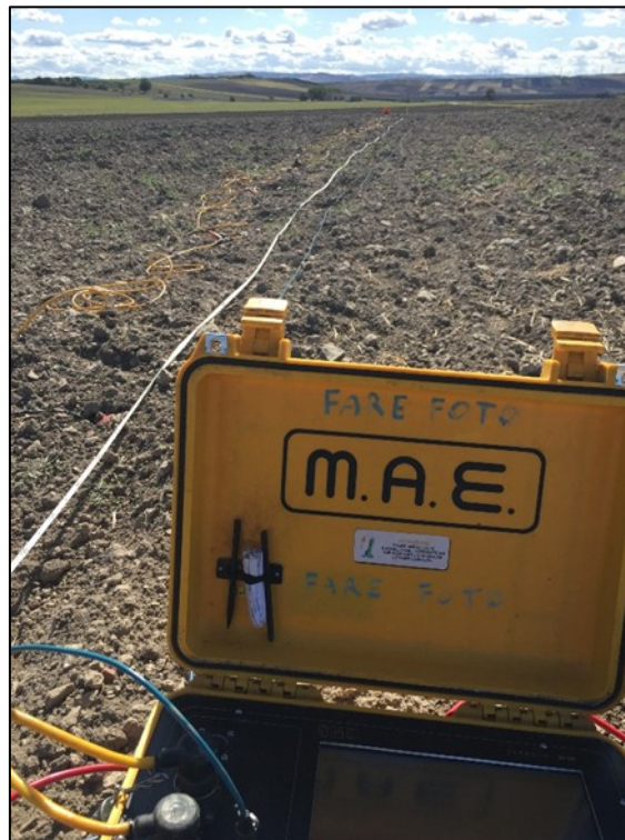
Figura 14 – Foto dello stendimento della prova geofisica MASW1.
