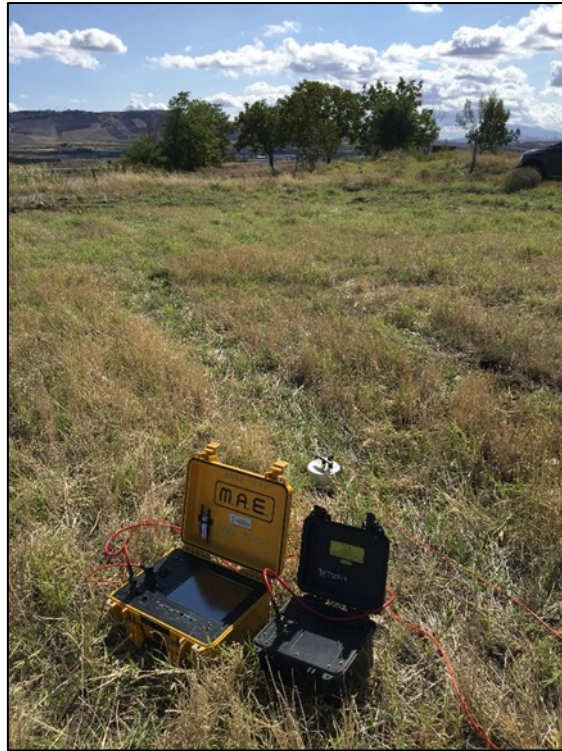
Figura 16 - Foto della realizzazione della prova di rumore ambientale HVSR.
