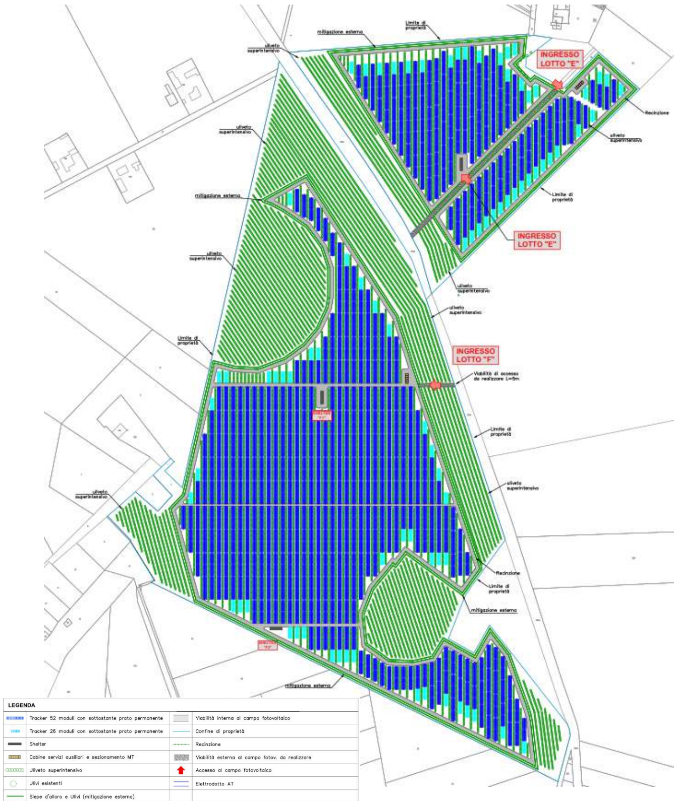
Fig. 4 Impianto agrivoltaico blocco "E" e "F" - aree destinate all'agricoltura e misure mitigative
