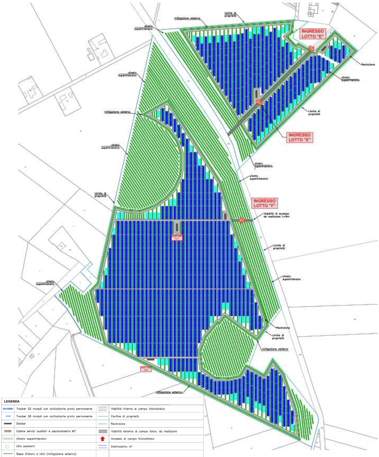
Fig. 5 Impianto agrivoltaico blocco "E" e "F" - aree destinate all'agricoltura e misure mitigative
