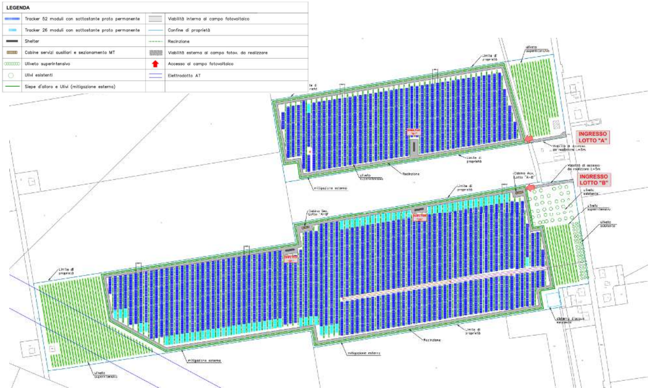
Fig. 3 Impianto agrivoltaico blocco "A" e "B" - aree destinate all'agricoltura e misure mitigative
