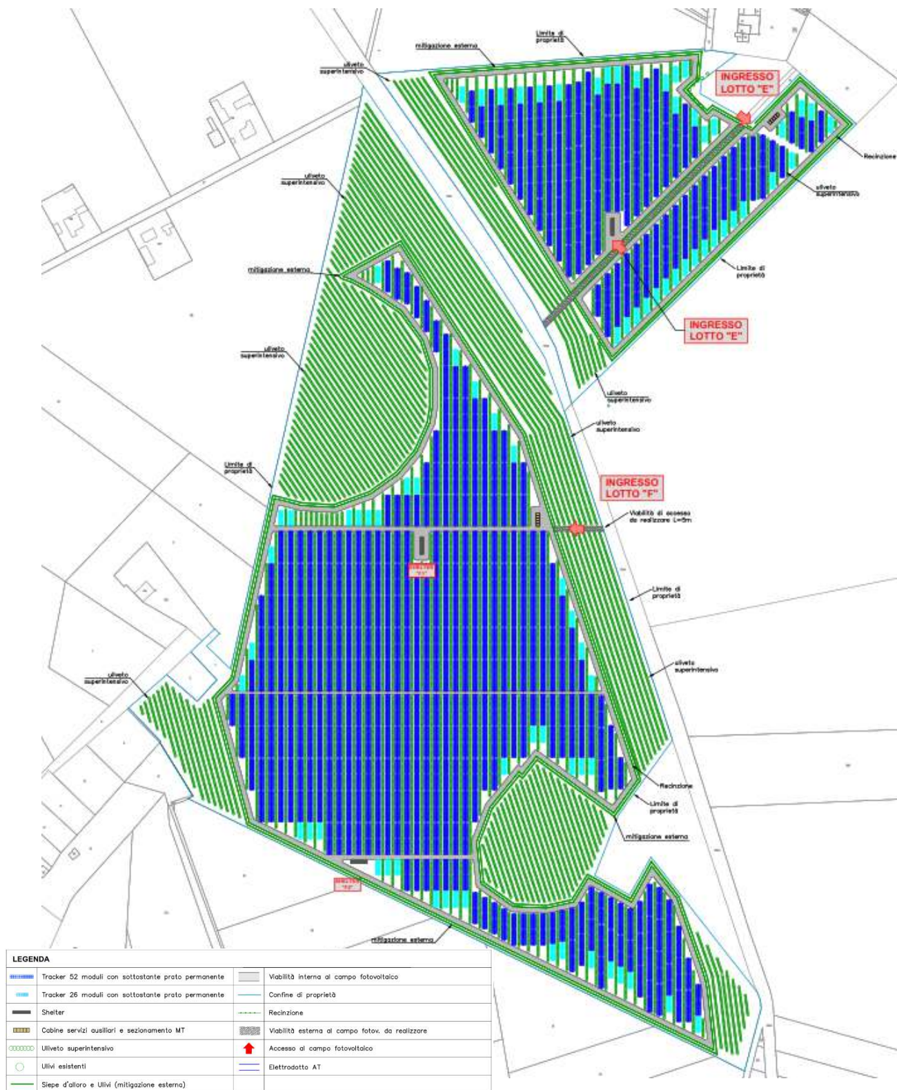
Fig. 4 Impianto agrivoltaico blocco "E" e "F" - aree destinate all'agricoltura e misure mitigative
