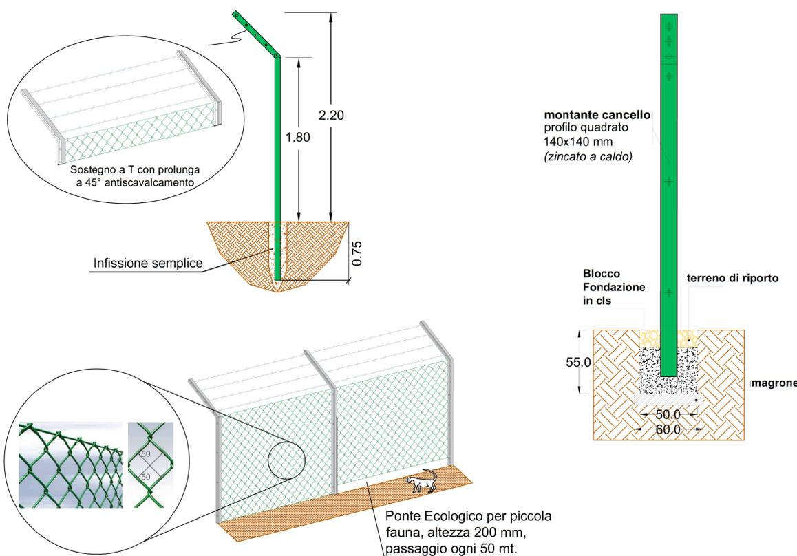
Rete metallica a semplice torsione, maglia quadrata 50x50 mm, in filo zincato a caldo diametro 2,5 mm plastificato tramite processo di sinterizzazione con PVC color verde diametro esterno 3 mm
