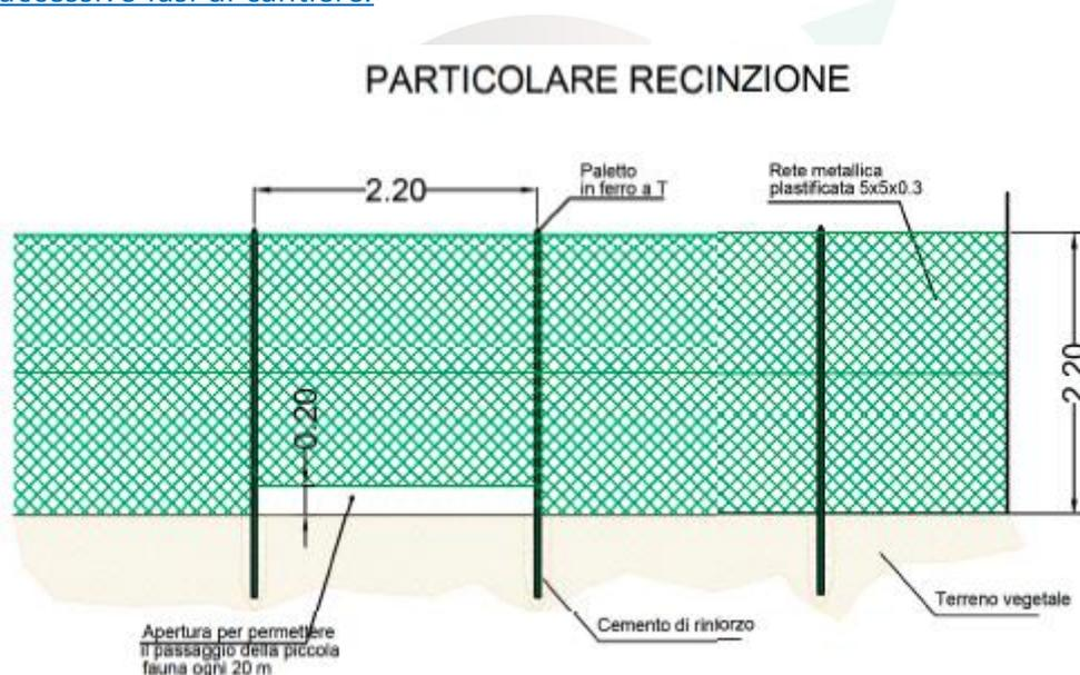
In dettaglio, si prevede di realizzare una recinzione di tutta l'area di impianto e delle relative pertinenze. Parallelamente alla recinzione è prevista una viabilità perimetrale che, oltre a consentire un'agile manutenzione e sorveglianza degli impianti, sarà anche funzionale a distanziare le componenti elettricamente connesse dalle aree esterne all'iniziativa.
