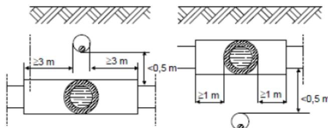
Nei casi di percorsi paralleli tra canalizzazioni per cavi elettrici e tubazioni del gas la distanza misurata tra le due superfici affacciate deve essere:
