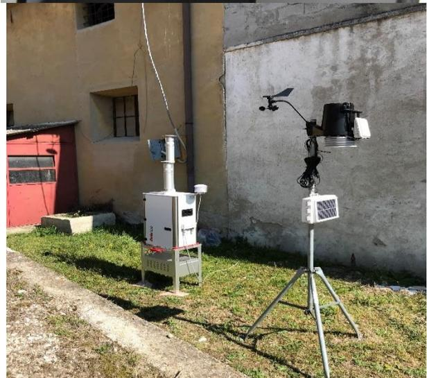
**Figure 4.1 - Allestimento Laboratorio Mobile – Analizzatori e Campionatori Sequenziali**
