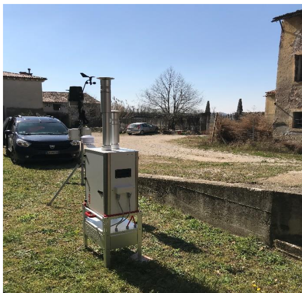
Figure 4.1 - Allestimento Laboratorio Mobile – Analizzatori e Campionatori Sequenziali
