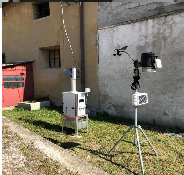
Figure 4.1 - Allestimento Laboratorio Mobile – Analizzatori e Campionatori Sequenziali
