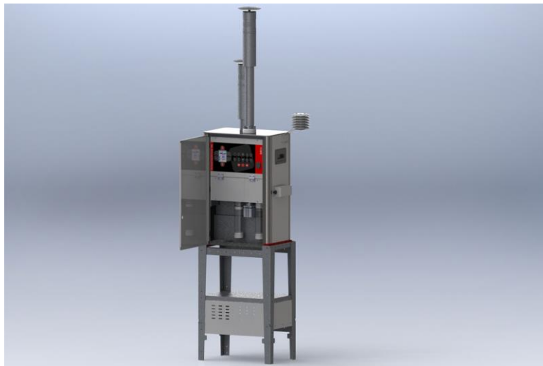
Figura 5.2.1 - GEMINI utilizzato per il monitoraggio delle polveri
