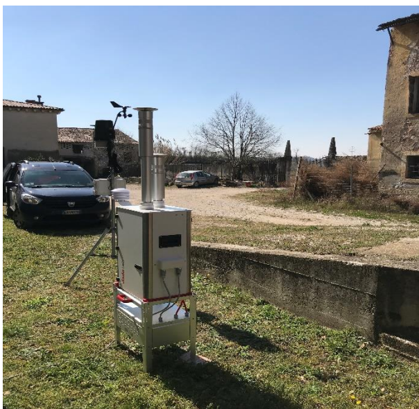
Figure 4.1 - Allestimento Laboratorio Mobile – Analizzatori e Campionatori Sequenziali
