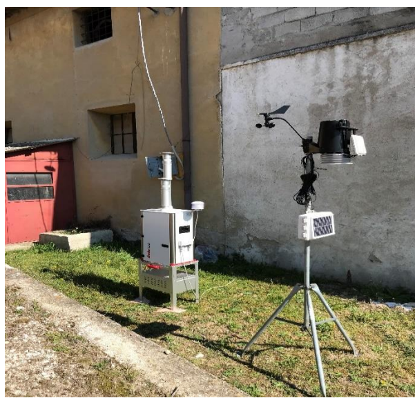
Figure 4.1 - Allestimento Laboratorio Mobile – Analizzatori e Campionatori Sequenziali
