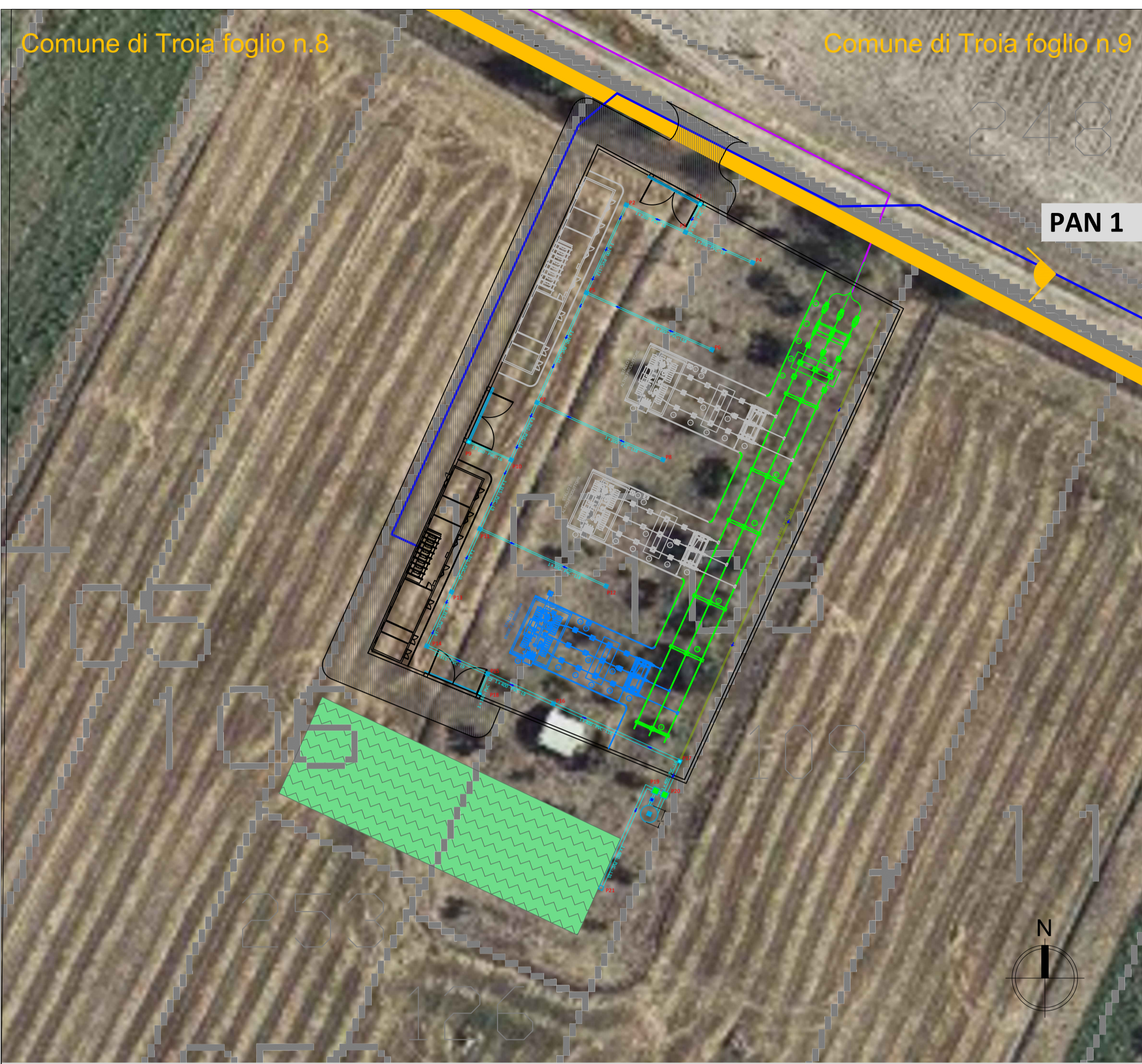
Rete di raccolta e smaltimento acque meteoriche planimetria catastale - scala 1:500
