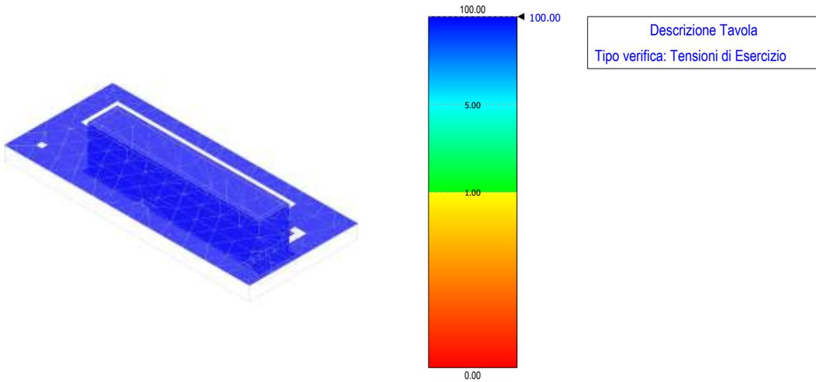
**Figura 85 – tensioni di esercizio - fondazione cabina di raccolta**
