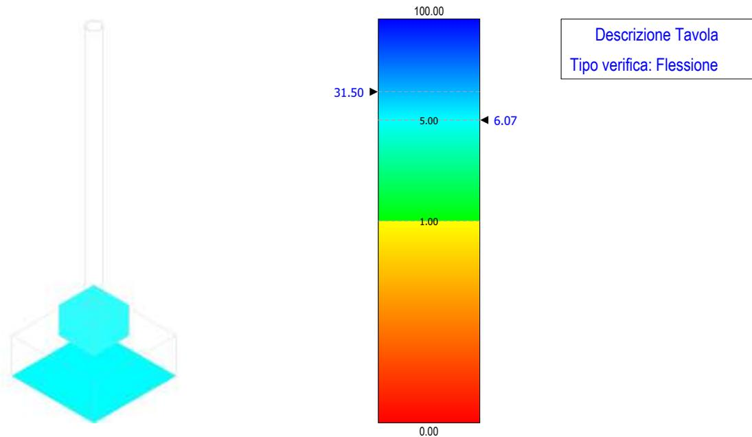
Figura 66 - verifica a flessione – fondazione scaricatore
