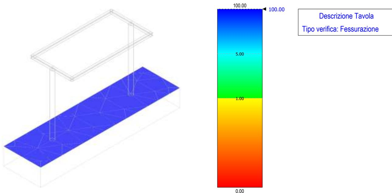
Figura 100 – verifica a fessurazione – fondazione sezionatore
