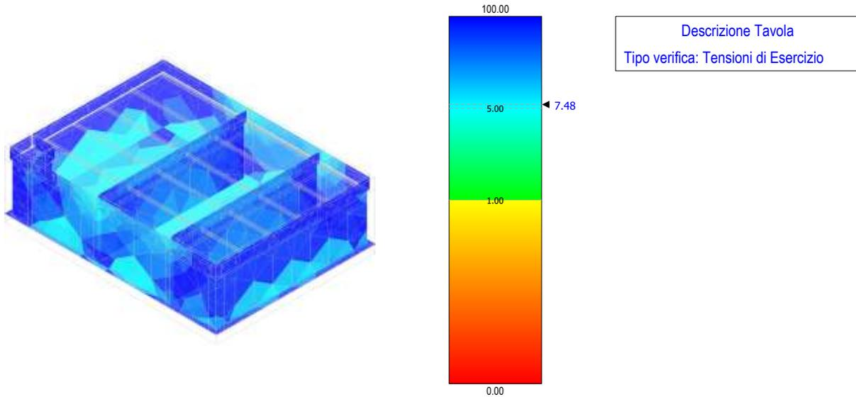
**Figura 87 – tensioni di esercizio – fondazione trasformatore**
