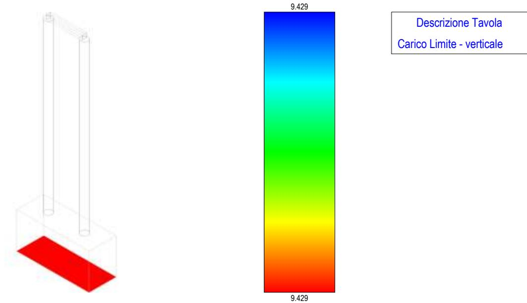
**Figura 121 - carico limite – fondazione arrivo cavi MT**
