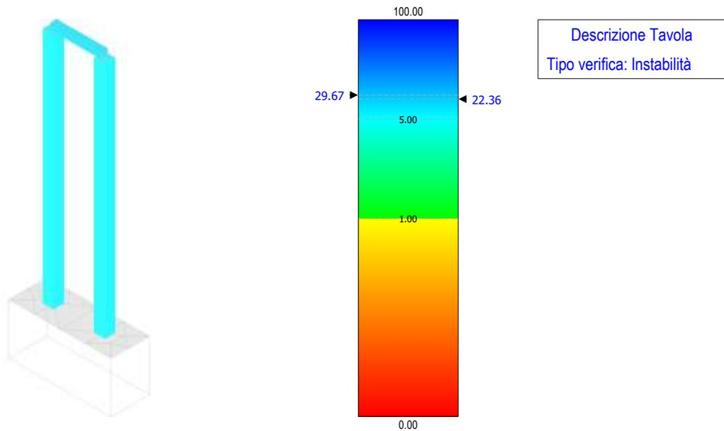
Figura 53 - verifica instabilità – arrivo cavi MT
