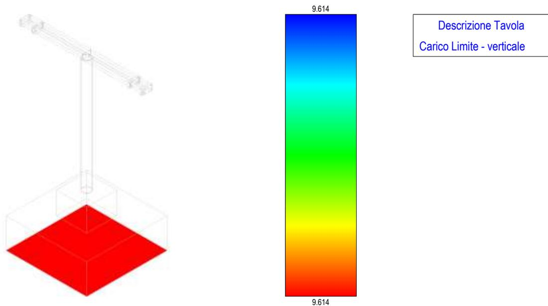
**Figura 116 - carico limite – fondazione terminale cavo AT**
