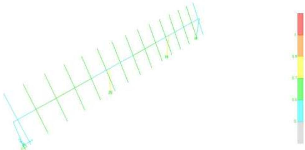
Figura 24 - coefficienti di sicurezza verifica di instabilità configurazione 2x14\_60°
