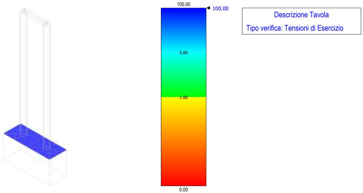
Figura 105 – tensioni di esercizio – fondazione arrivo cavi MT
