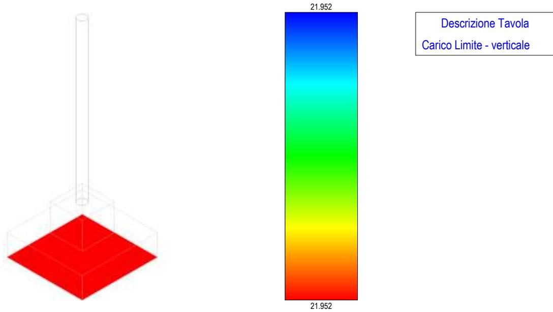
**Figura 115 - carico limite – fondazione TA**
