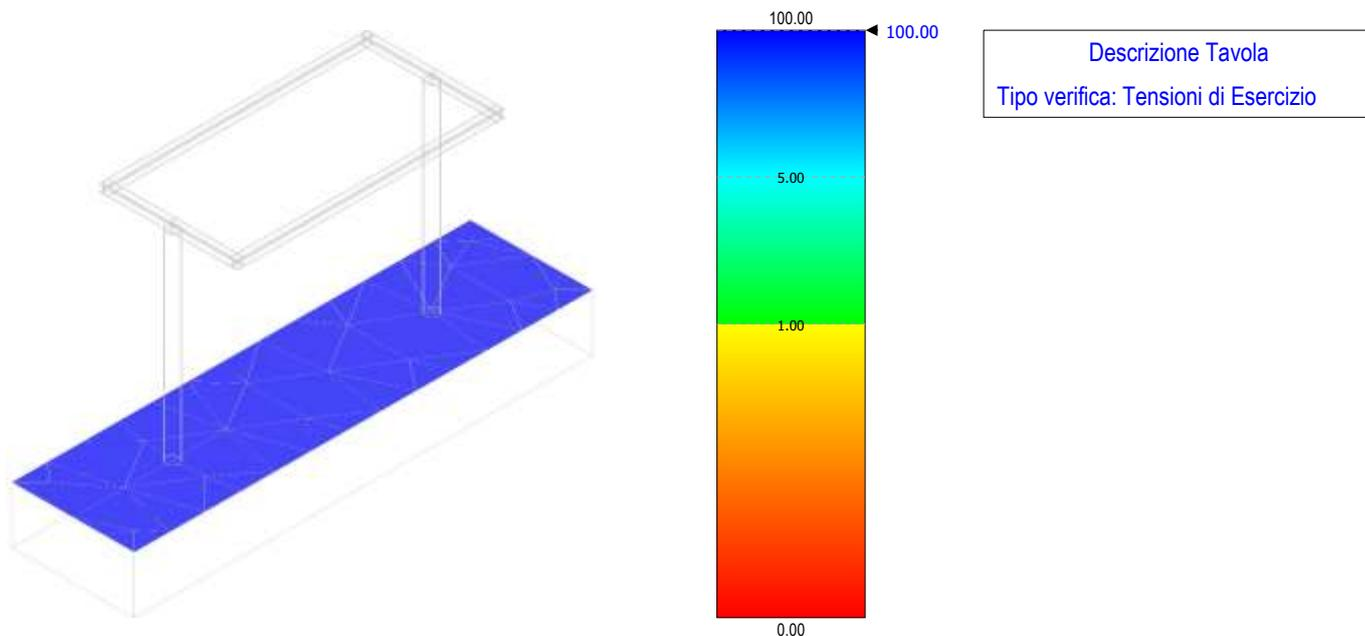
Figura 99 – tensioni di esercizio – fondazione sezionatore
