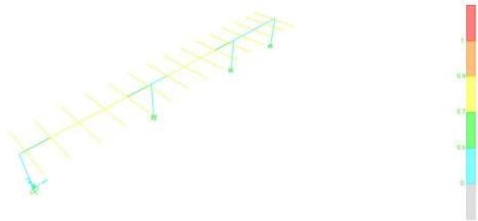
**Figura 27 - coefficienti di sicurezza verifica a taglio configurazione 2x14\_0°**
