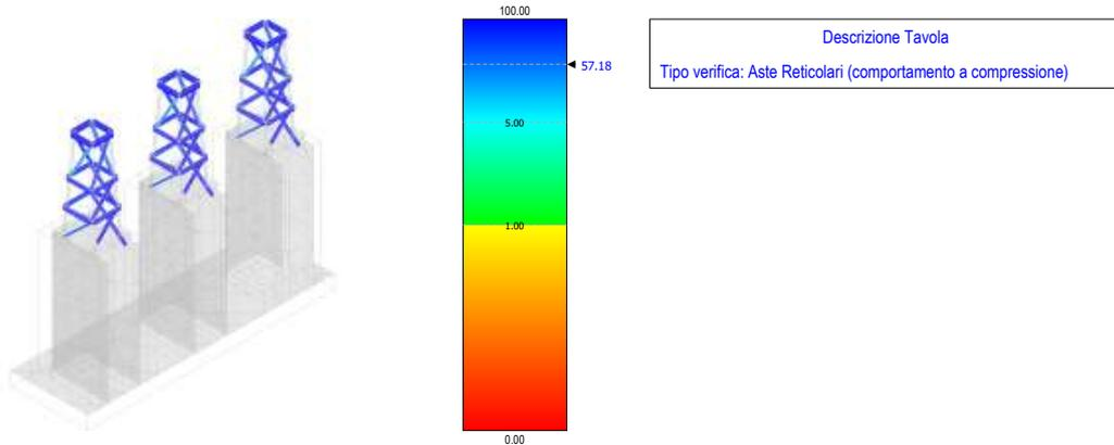
Figura 57 - verifica a trazione aste reticolari – arrivo cavo AT area Terna
