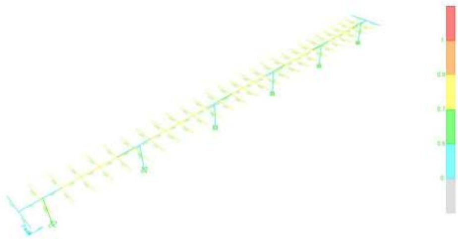
Figura 22 - coefficienti di sicurezza verifica di instabilità configurazione 2x28\_0°
