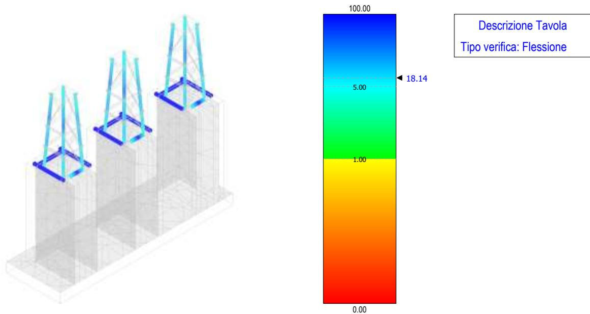
Figura 37 - verifica a flessione – terminale cavo AT
