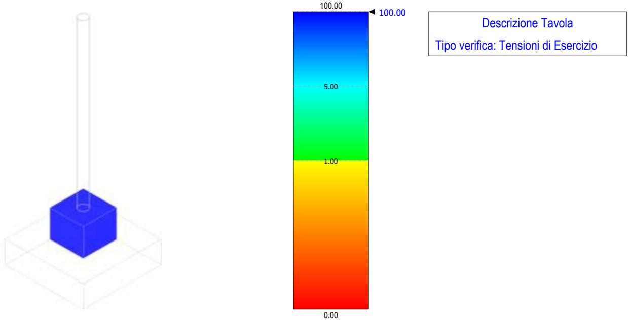
Figura 93 – tensioni di esercizio – fondazione TA
