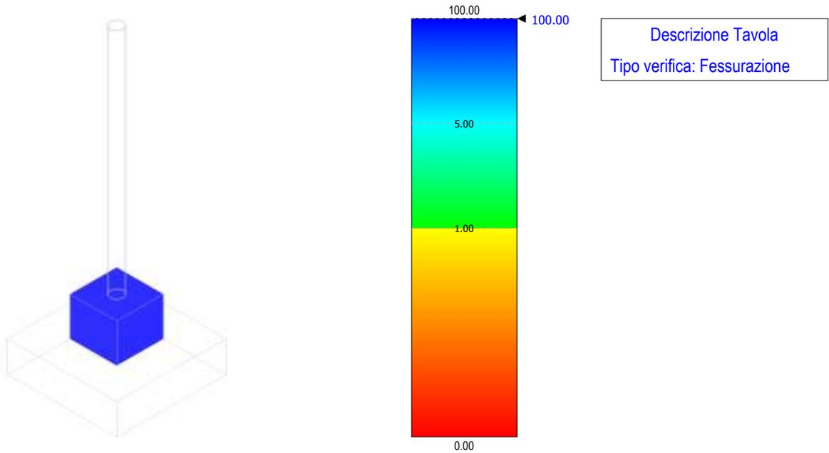
Figura 94 – verifica a fessurazione – fondazione TA
