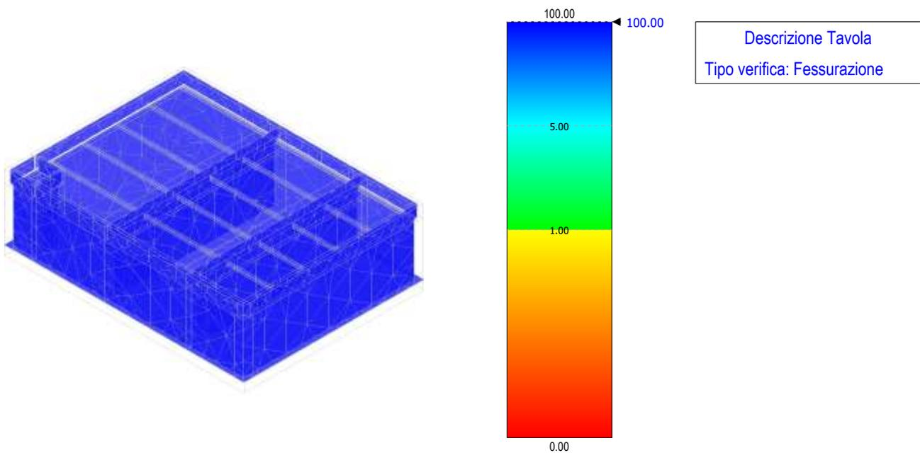
**Figura 88 – verifica a fessurazione – fondazione trasformatore**
