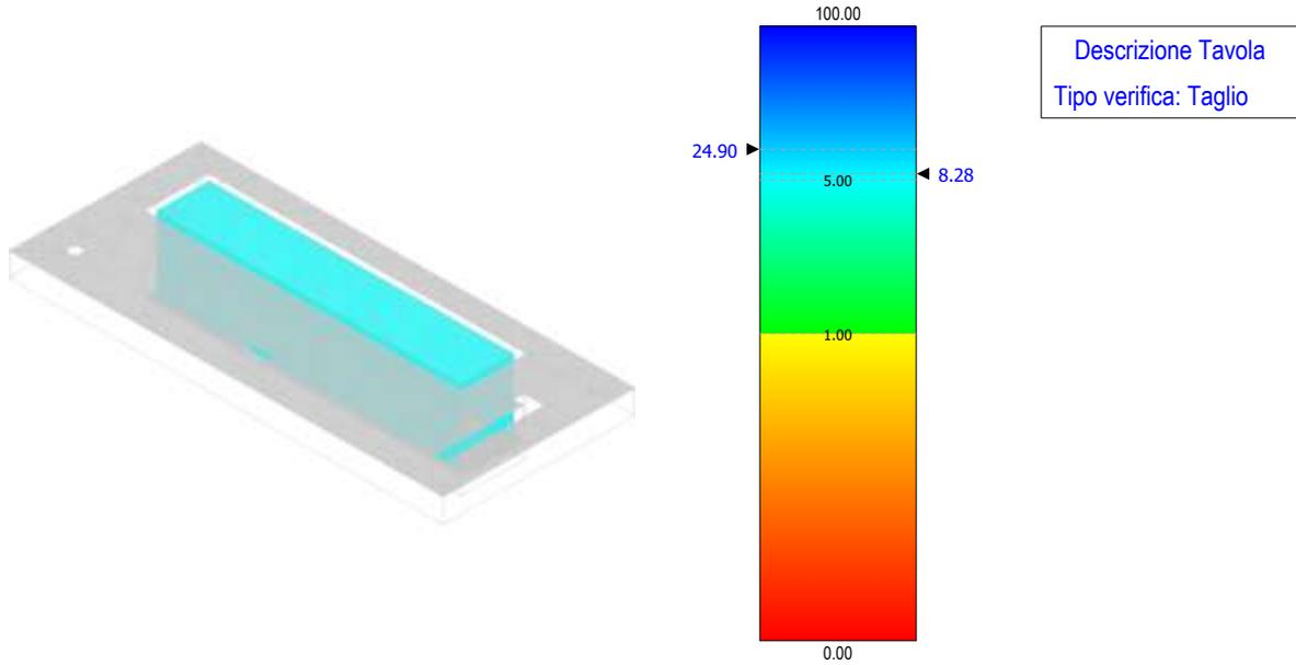
Figura 63 - verifica a taglio – fondazione cabina di raccolta
