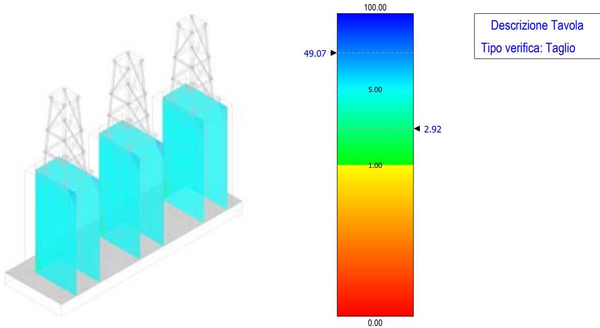
Figura 73 - verifica a taglio – fondazione terminale cavo AT
