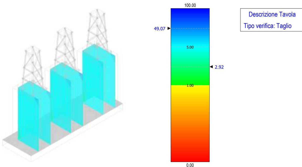
Figura 84 - verifica a taglio – fondazione arrivo cavo AT area Terna
