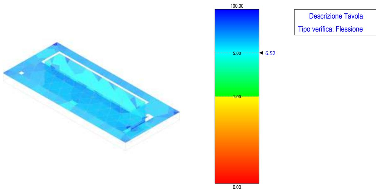
Figura 62 - verifica a flessione - fondazione cabina di raccolta
