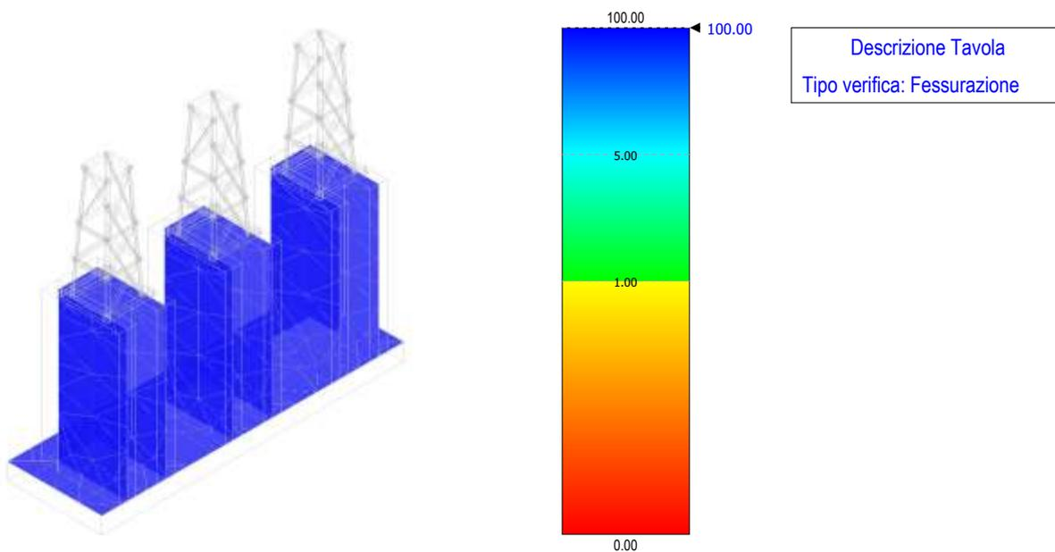
Figura 96 – verifica a fessurazione – fondazione terminale cavo AT
