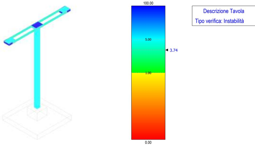
Figura 50 - verifica instabilità – sbarre AT
