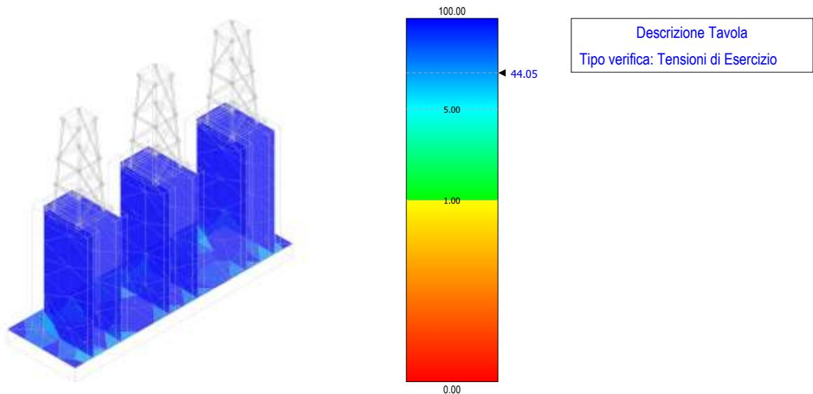
**Figura 109 – tensioni di esercizio – fondazione arrivo cavo AT area Terna**
