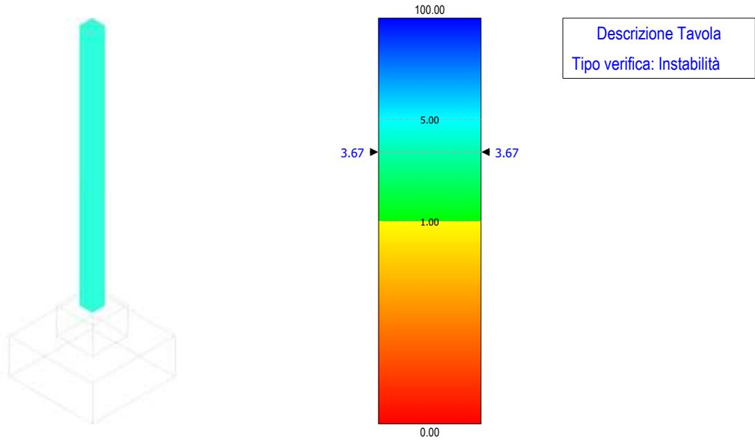
Figura 30 - verifica a instabilità – scaricatore
