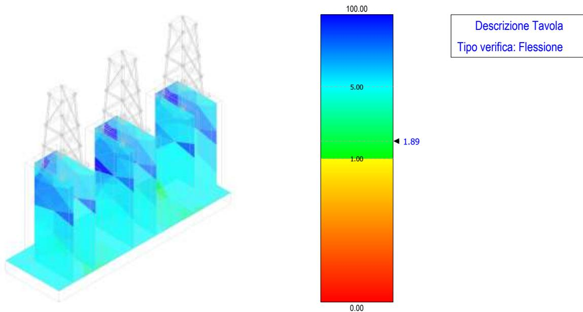
Figura 83 - verifica a flessione – fondazione cavo AT area Terna
