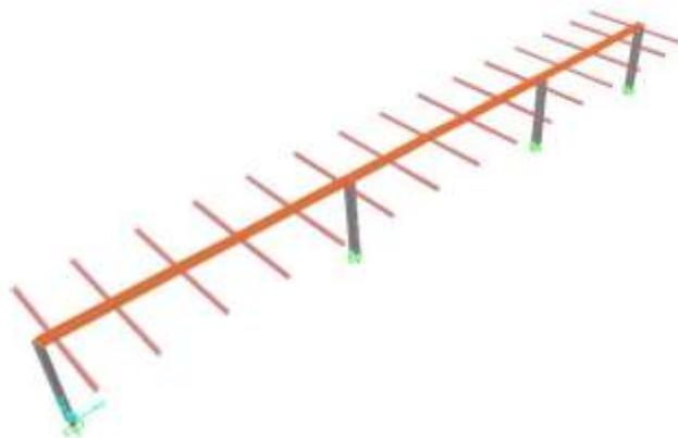
Figura 4 – Vista configurazione tracker 2x14\_0°
