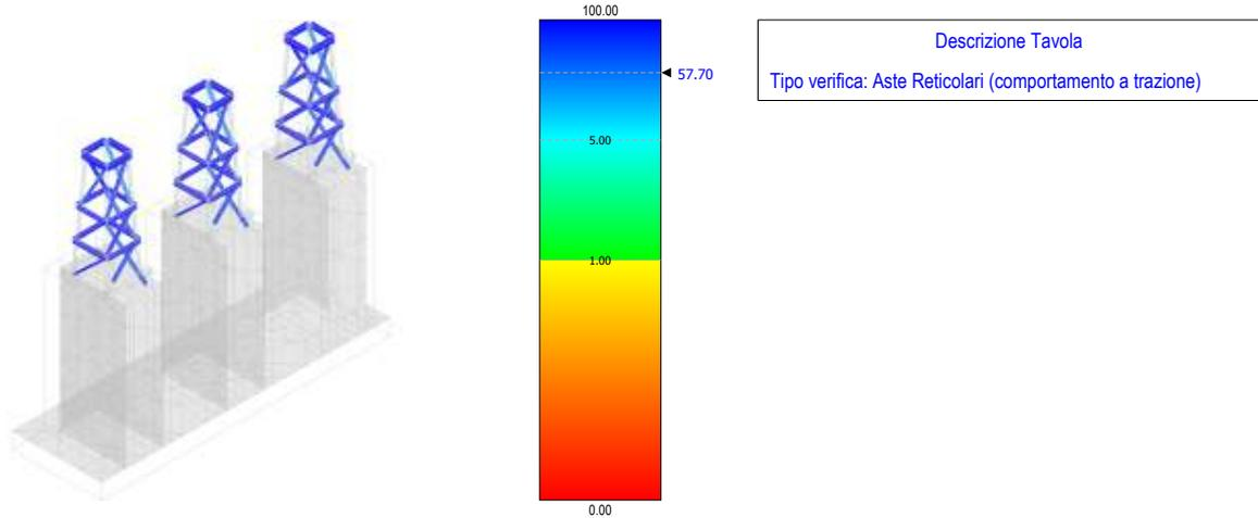
Figura 56 - verifica a trazione aste reticolari – arrivo cavo AT area Terna
