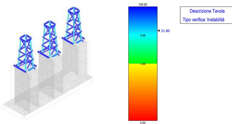
Figura 58 - verifica instabilità – arrivo cavo AT area Terna
