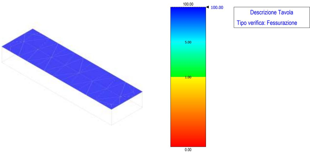
Figura 102 – verifica a fessurazione – fondazione interruttore
