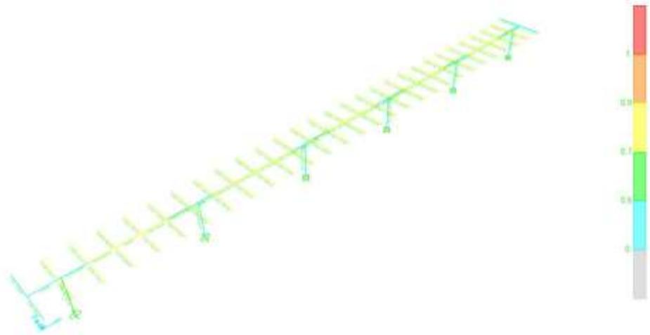
Figura 23 - coefficienti di sicurezza verifica a taglio configurazione 2x28\_0°
