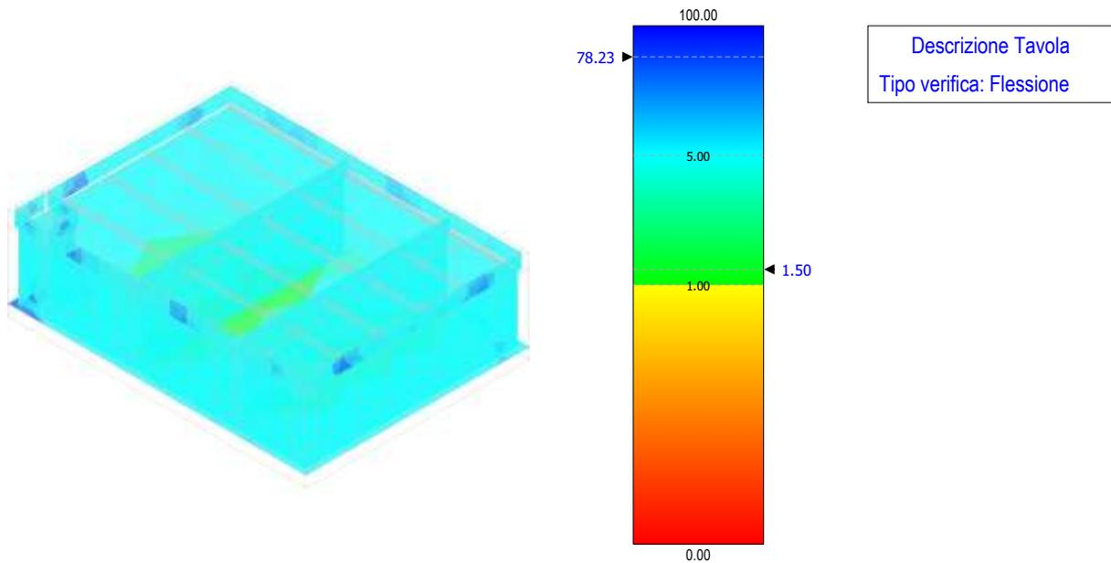
Figura 64 – verifica a flessione – fondazione trasformatore
