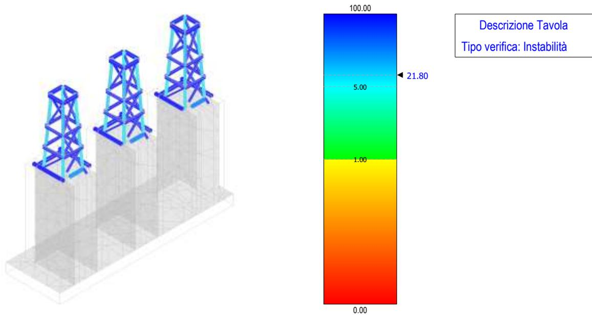
Figura 41 - verifica instabilità – terminale cavo AT
