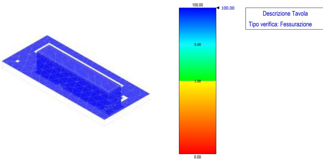
**Figura 86 – verifica a fessurazione - fondazione cabina di raccolta**
