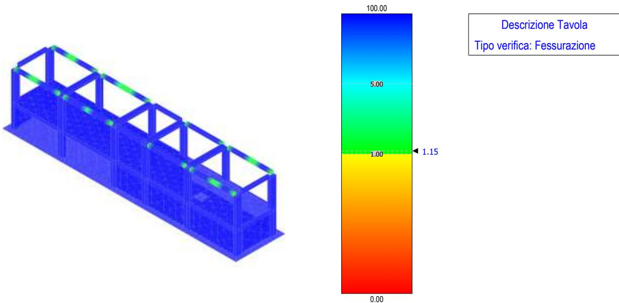
Figura 108 – verifica a fessurazione – edificio
