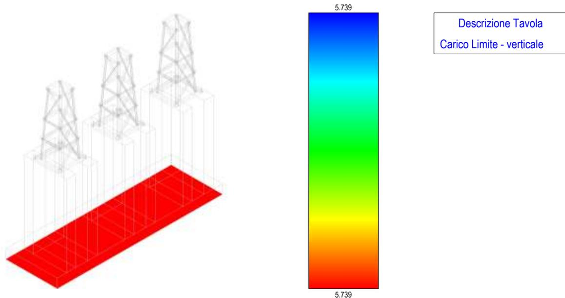
Figura 123 - carico limite – fondazione arrivo cavo AT area Terna
