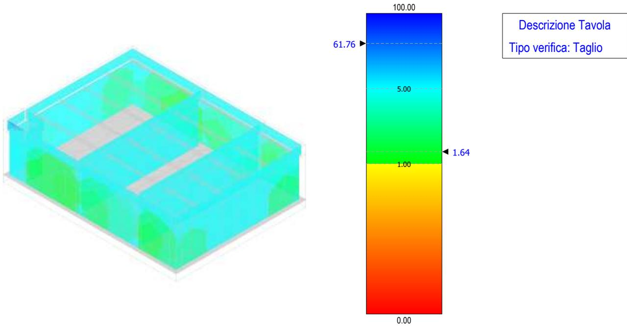
Figura 65 – verifica a taglio – fondazione trasformatore
