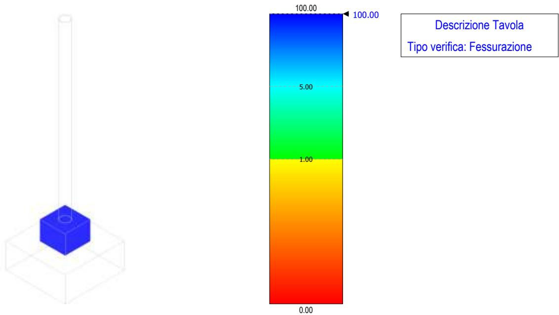
Figura 90 – verifica a fessurazione – fondazione scaricatore
