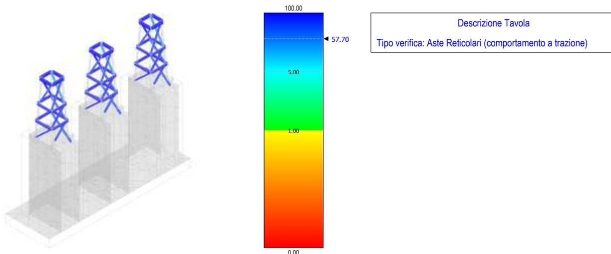
Figura 39 - verifica a trazione aste reticolari – terminale cavo AT
