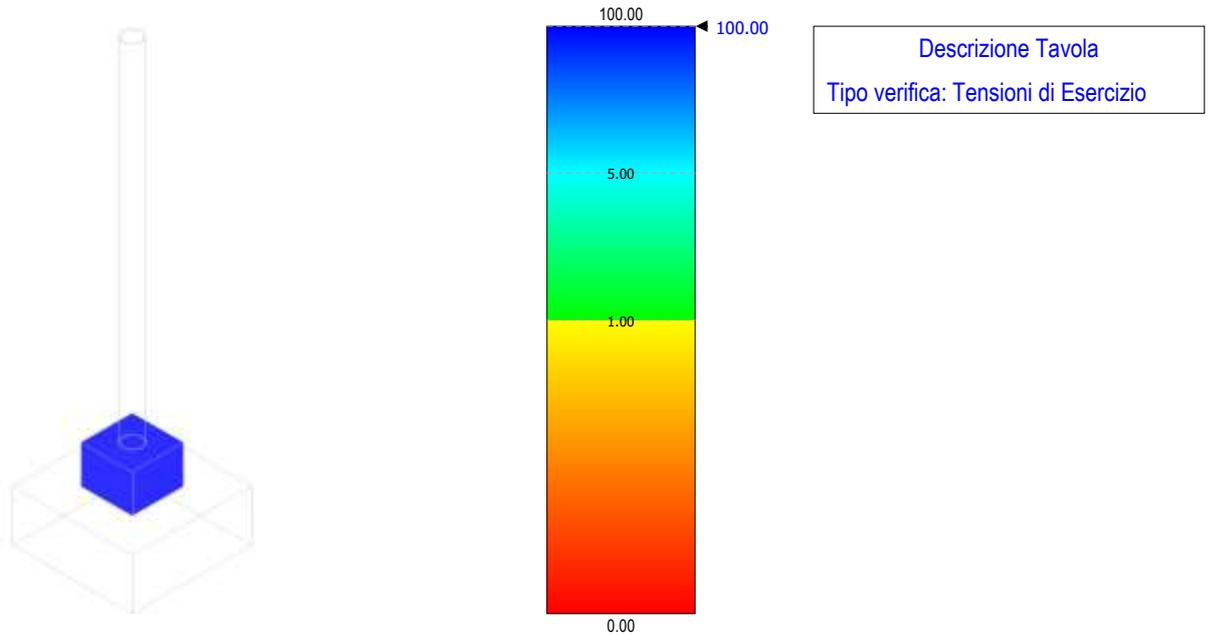
Figura 89 – tensioni di esercizio – fondazione scaricatore
