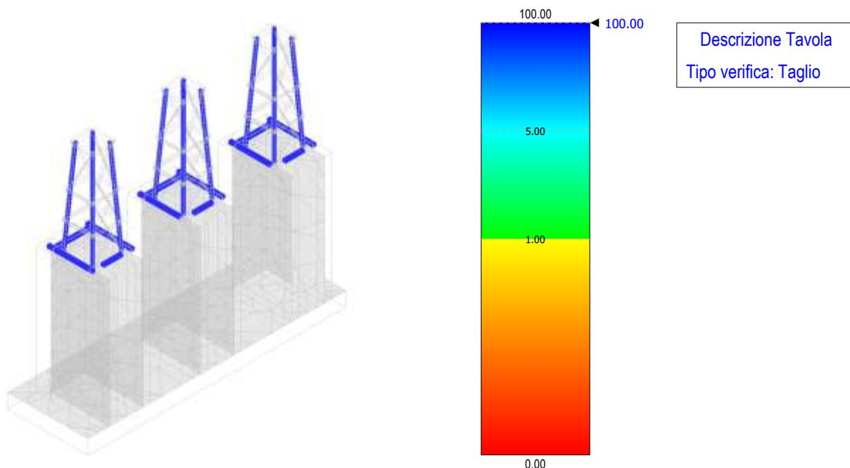
Figura 38 - verifica a taglio – terminale cavo AT
