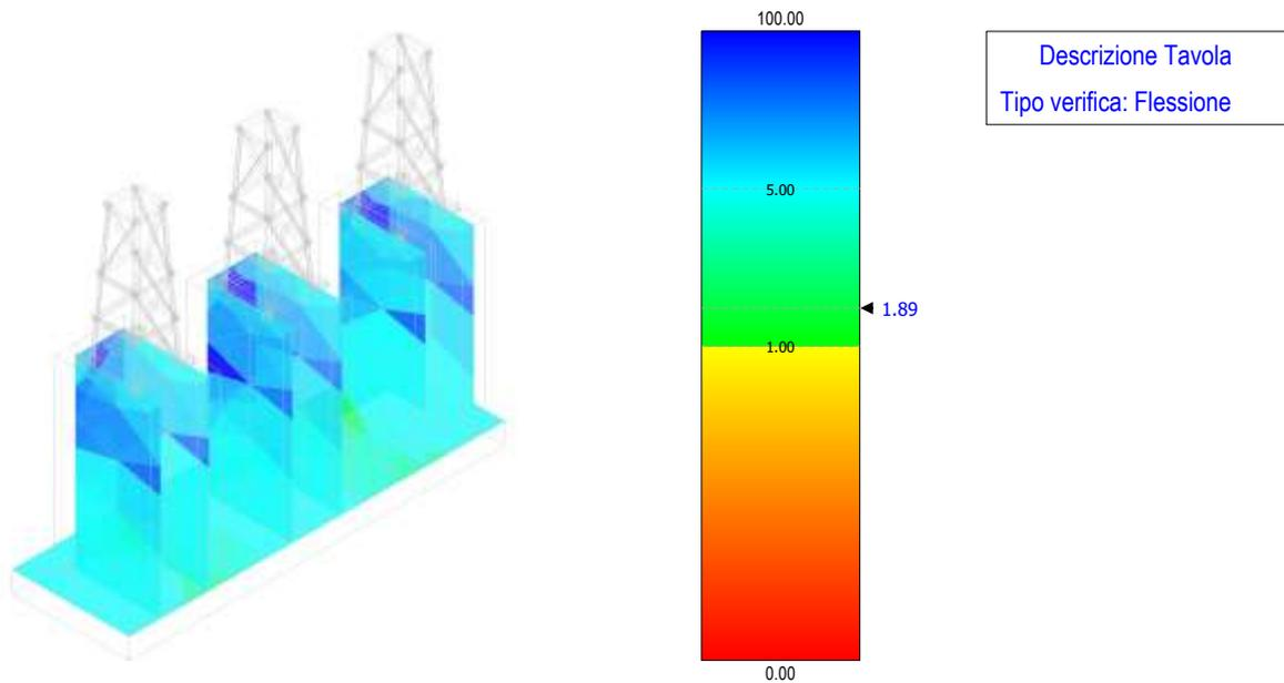
Figura 72 - verifica a flessione – fondazione terminale cavo AT
