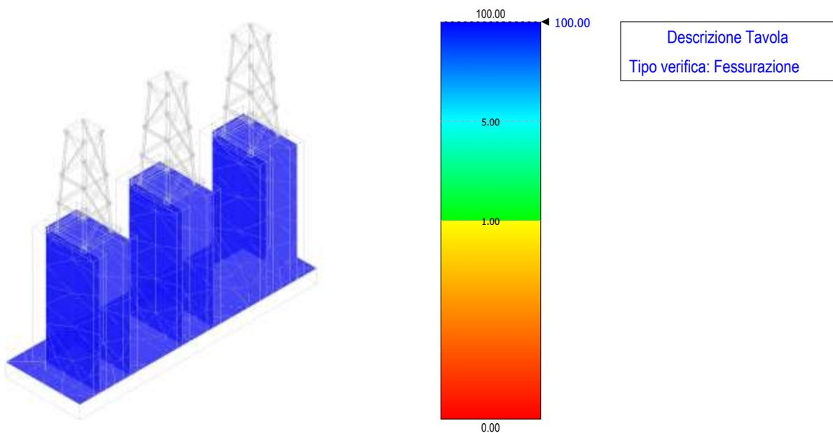
**Figura 110 – verifica a fessurazione – fondazione arrivo cavo AT area Terna**
