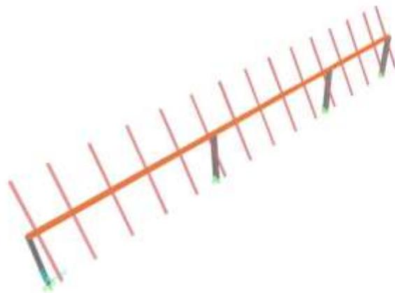
Figura 3 – Vista configurazione tracker 2x14\_60°
