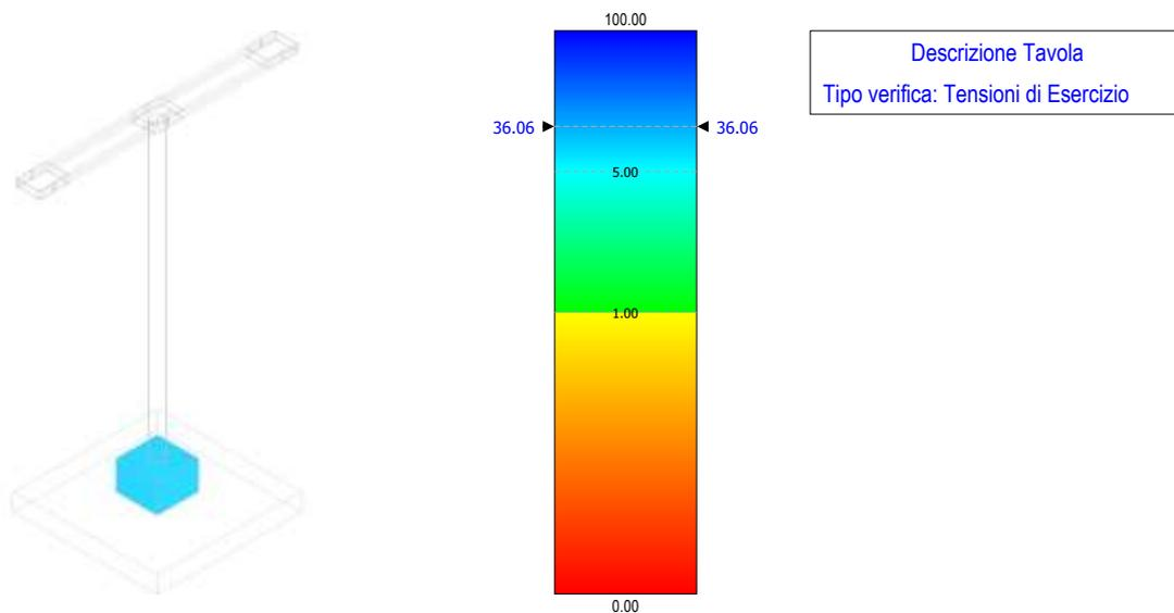
Figura 103 – tensioni di esercizio – fondazione sbarre AT
