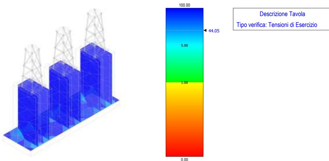
Figura 95 – tensioni di esercizio – fondazione terminale cavo AT
