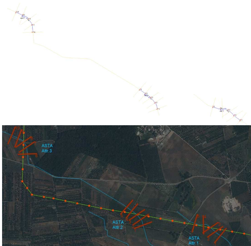
Figura 19 – Planimetria con indicazione delle sezioni su Hec-Ras
