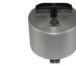
Sensore sismico 3D da superficie, frequenza geofoni 2 Hz, contenitore in alluminio, piedini di supporto per utilizzo su pavimentazione o infissione nel terreno, bolla di livellamento, maniglia di trasporto.
