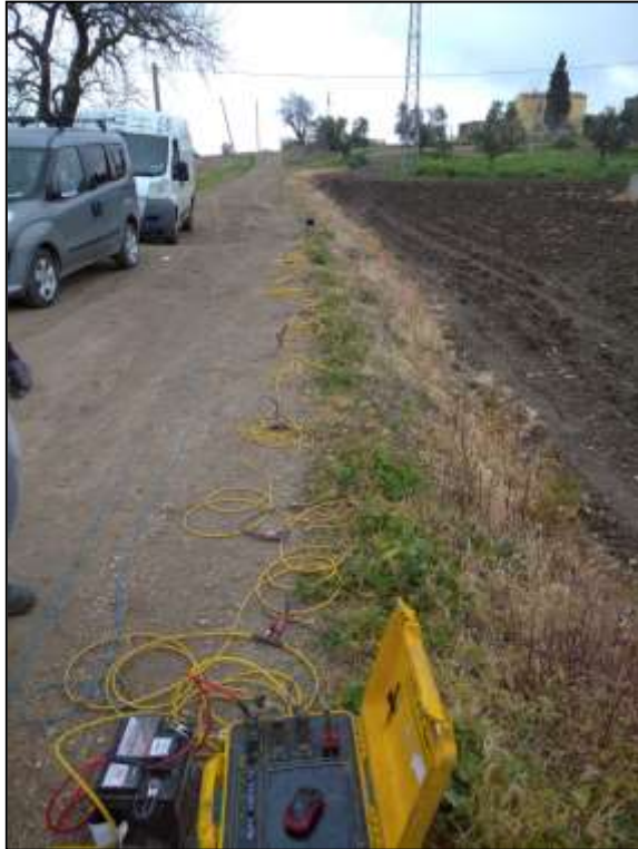
FOTO 1 dettaglio stendimento ERT2
