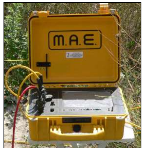
Fig. 3: sismografo multicanale M.A.E. modello A 6000 S.
