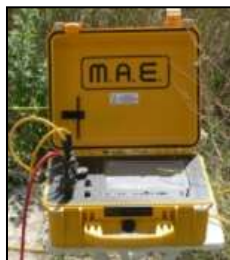
Fig. 2: sismografo multicanale M.A.E. modello A 6000 S.
