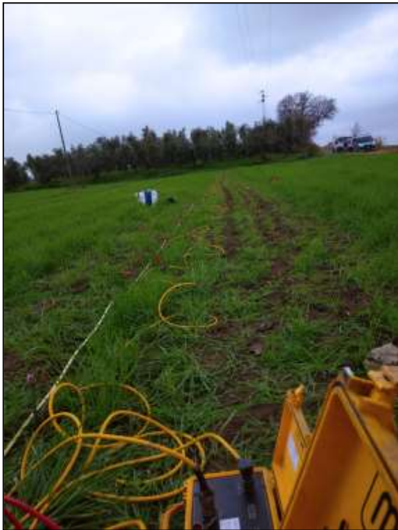
FOTO 1 dettaglio stendimento ERT1
