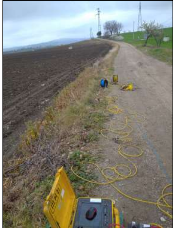
FOTO 2 Dettaglio stendimento ERT2
