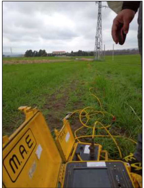
FOTO 2 Dettaglio stendimento ERT1
