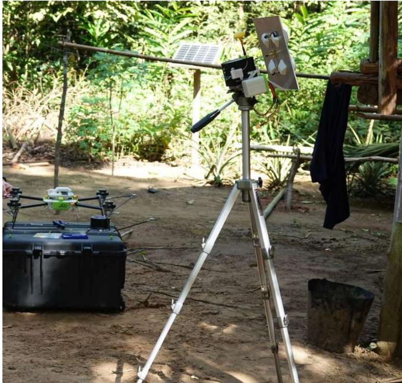
Esistono testimonianze di aziende che impiegano nella gestione delle proprie coltivazioni sofisticati kit dotati di sensoristica avanzata, con batterie ad alimentazione solare, che dispongono di sensori ambientali-vegetazionali e meteorologici. I kit si compongono di un sistema di water intelligence che misura in tempo reale le necessità idriche delle coltivazioni, nonché di un pannello di monitoraggio – web o su mobile app – per verificare in autonomia lo stato idrico delle piante.
