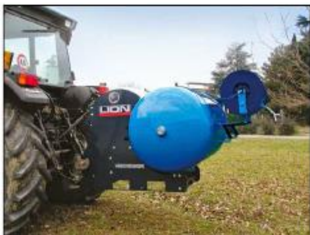
Compressore PTO per il funzionamento di strumenti pneumatici per l'arboricoltura
