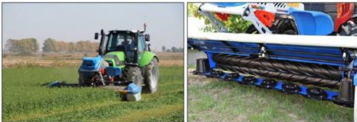
Esempio di falciacondizionatrice frontale e particolare dei rulli in gomma
