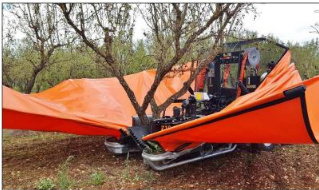
Macchina frontale per la raccolta delle mandorle su impianto intensivo e disposizione ideale degli alberi per il corretto impiego della stessa
