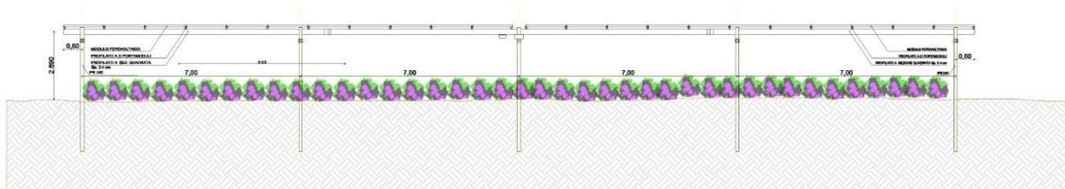
L'inseguitore solare serve ad ottimizzare la produzione elettrica dell'effetto fotovoltaico (il silicio cristallino risulta molto sensibile al grado di incidenza della luce che ne colpisce la superficie) ed utilizza la tecnica del backtracking, per evitare fenomeni di ombreggiamento a ridosso dell'alba e del tramonto. In pratica nelle prime ore della giornata e prima del tramonto i moduli non sono
