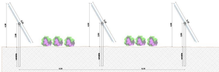
L'altezza dei pali di sostegno è stata fissata in modo tale che lo spazio libero tra il piano campagna ed i moduli, alla massima inclinazione, sia superiore a 0,40 m, per agevolare la fruizione del suolo per le attività agricole. Di conseguenza, l'altezza massima raggiunta dai moduli è di 4.98 m.
