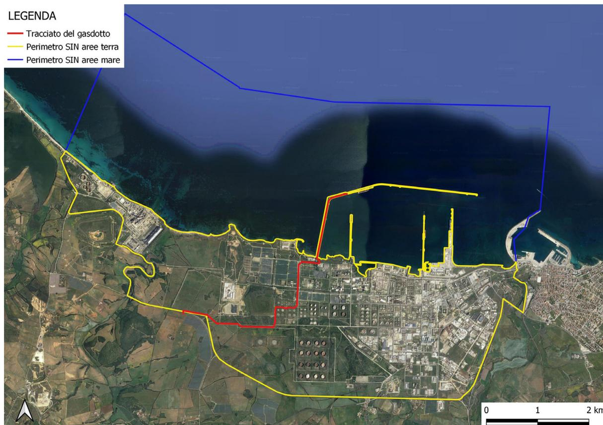
**Figura 3.1-1: Stralcio immagine aerea con localizzazione dell'area di intervento: in rosso il tracciato di progetto dell'opera, in giallo la perimetrazione del SIN area a terra, e in blu la perimetrazione del SIN area a mare**
