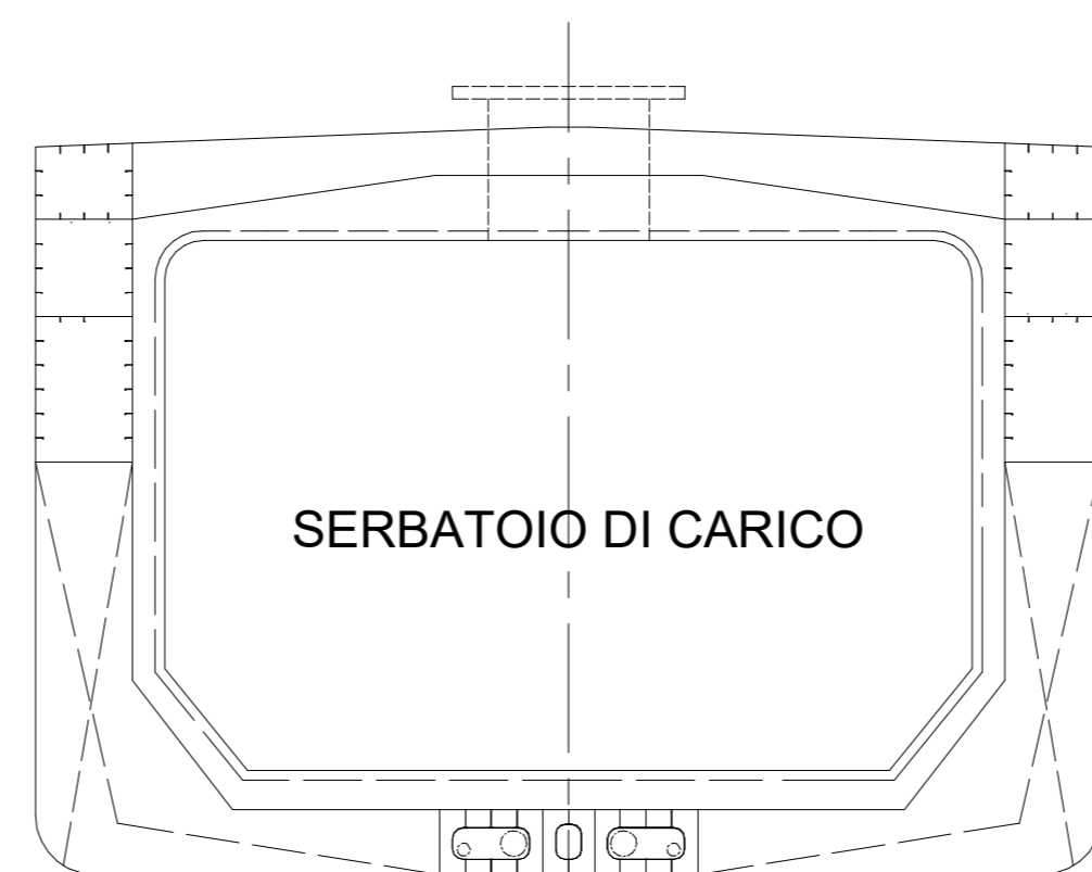
SEZIONE TIPICA DEI SERBATOI DI CARICO
