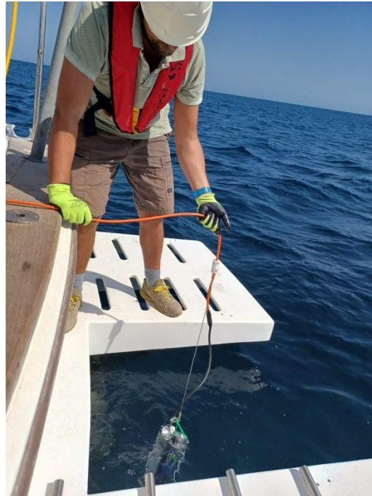
Figura 6.1: Operatore durante la profilazione della colonna d'acqua per mezzo di sonda CTD.
