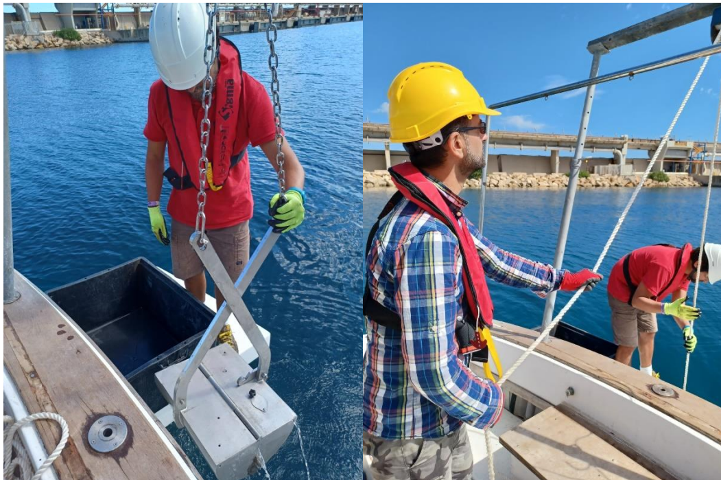
Figura 6.3: Operatori durante il campionamento dei sedimenti per mezzo di benna Van-Veen.
