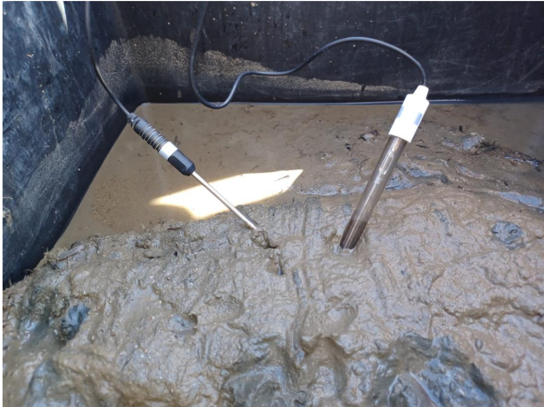
Figura 6.4: Misurazione di temperature e pH dei campioni di sedimento
