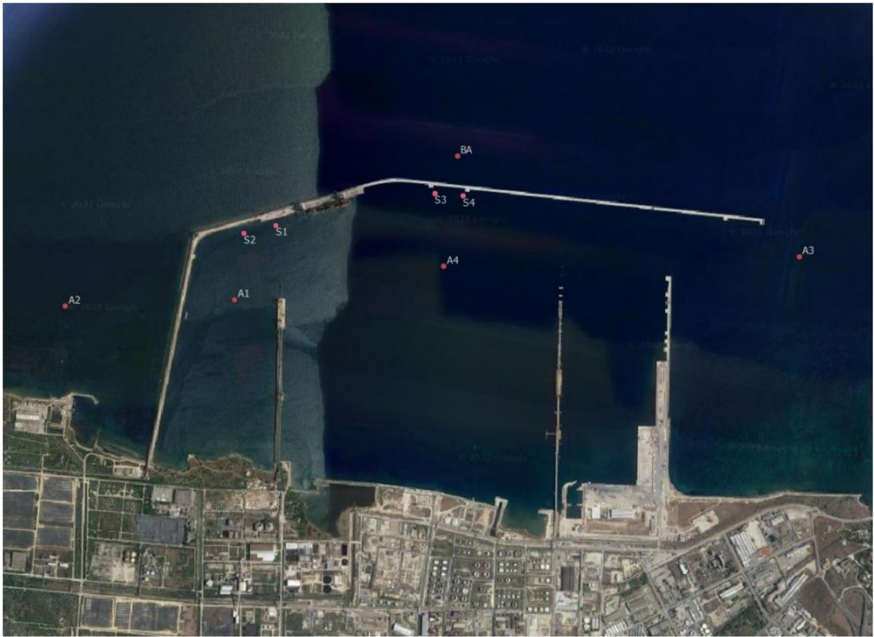
Figura 1: Punti di prelievo dei sedimenti marini (S1, S2, S3 e S4) e punti di prelievo di acque marine (A1, A2, A3, A4 e BA).
