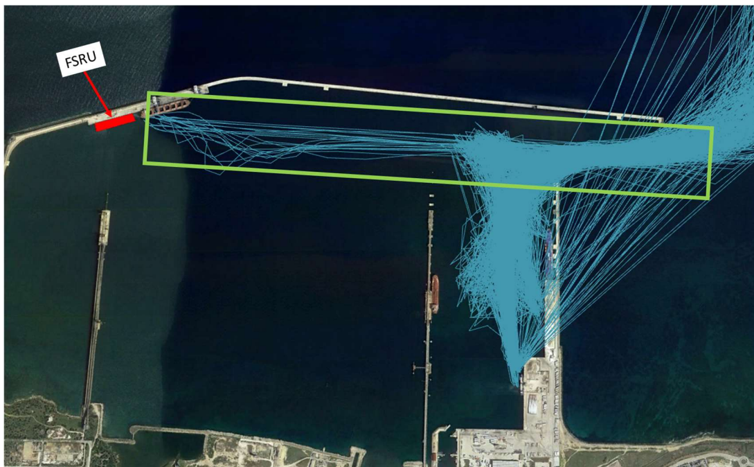
Figura 5-8: Tratto orizzontale in cui le navi sono in rotta di collisione con la posizione dell'FSRU (rappresentata sulle rotte di classe GRT 5)
