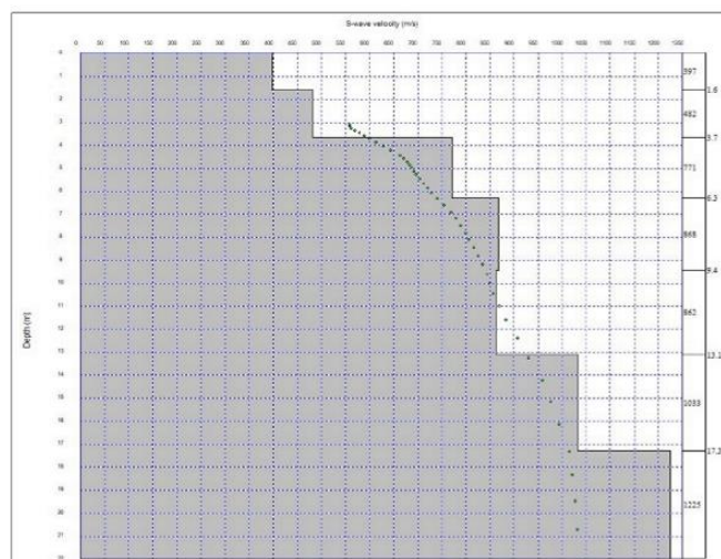
Figura 17. modello stratigrafico delle V_s
