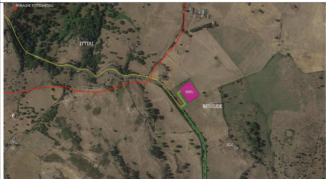
*Fig. 37 – Area della Sottostazione Elettrica Utente (in verde il cavidotto in MT, in giallo quello in AT)*
