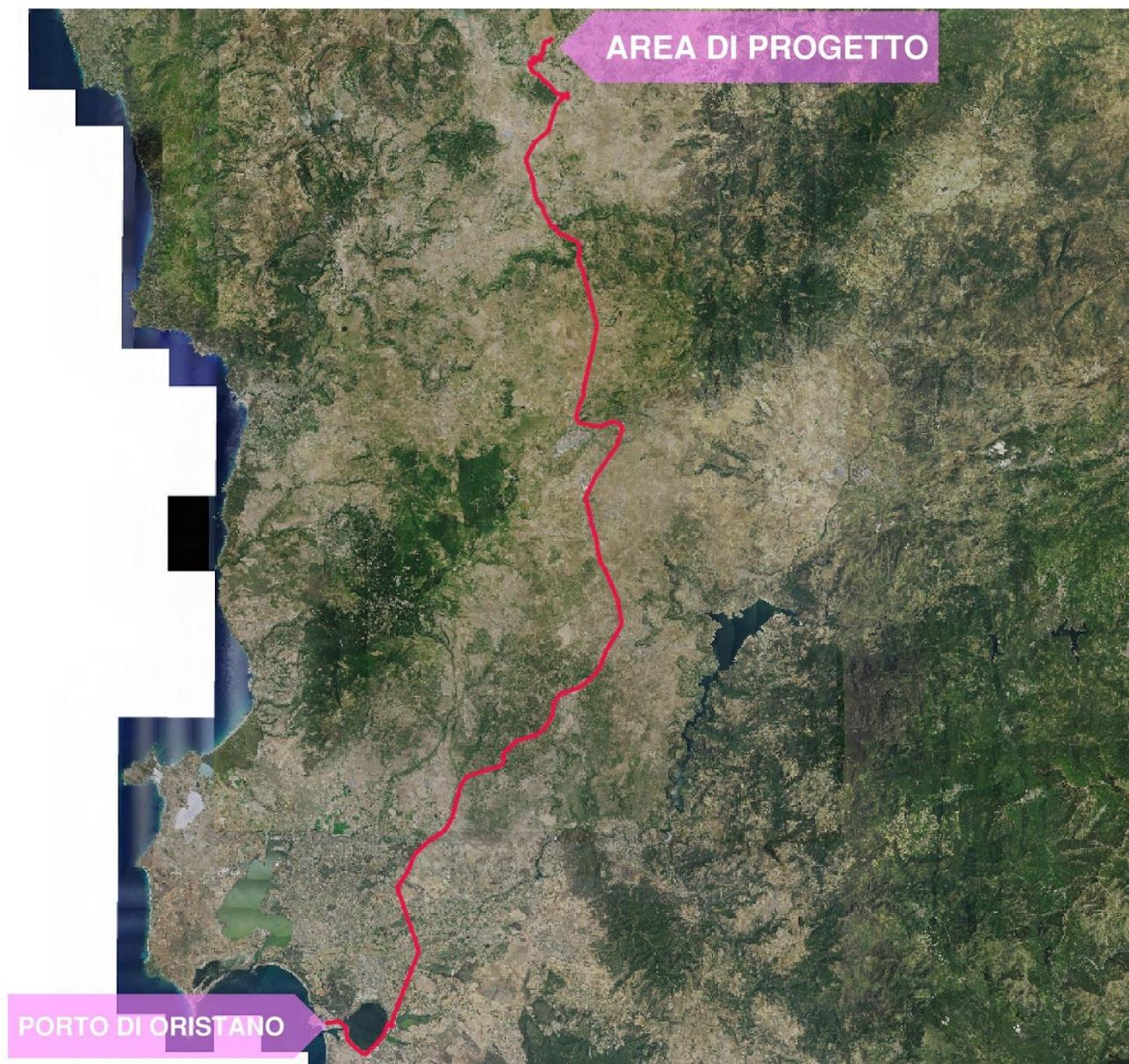
Figura 4.98 - Tragitto della viabilità principale di accesso al sito di progetto ai fini del trasporto della componentistica degli aerogeneratori
