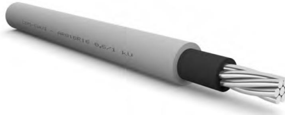
Figura 14 - Cavo BT: ARG16R16 0,6/1 kV
