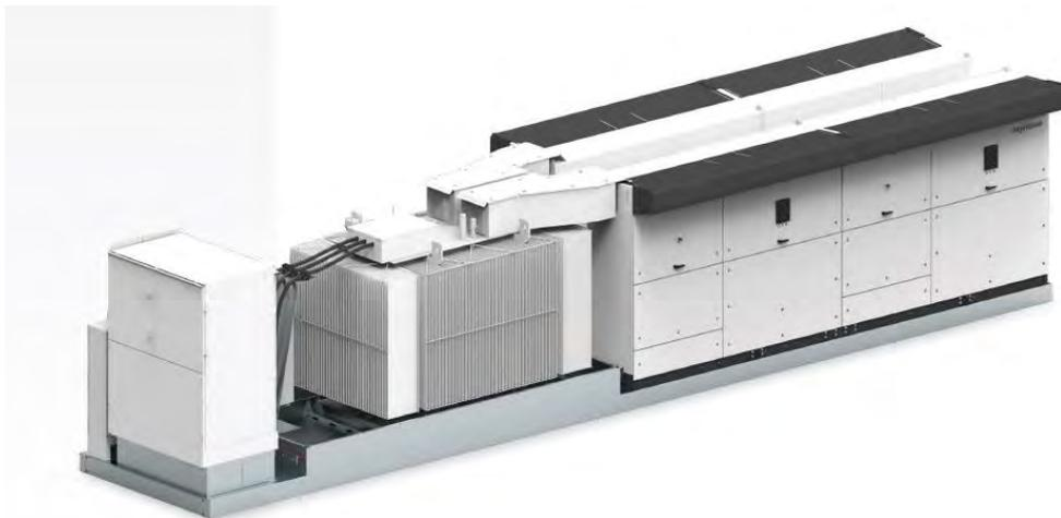
I componenti esterni sono montati su un telaio di base, realizzato in acciaio zincato a caldo. Tutti i componenti compresi gli inverter sono integrati sul telaio di base, completamente cablati e testati in fabbrica, mentre il trasformatore MT viene fornito preassemblato per una connessione veloce in loco.
