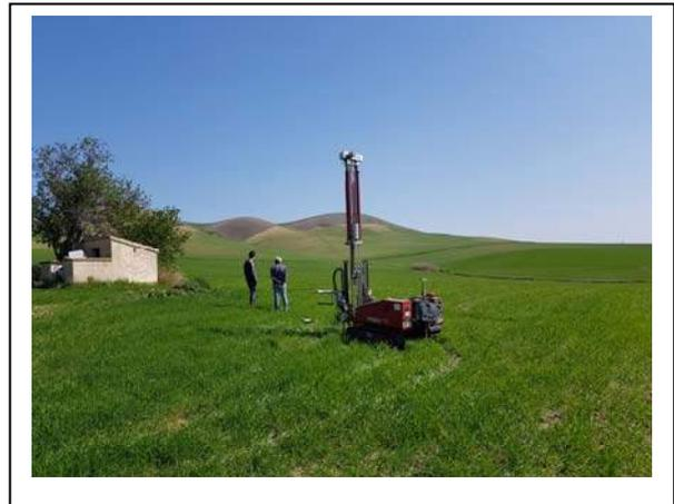
La prova n. 1 è stata portata fino alla quota di 8.20 metri registrando un andamento circa costante. Di seguito la diagrafia risultante dalle prove.
