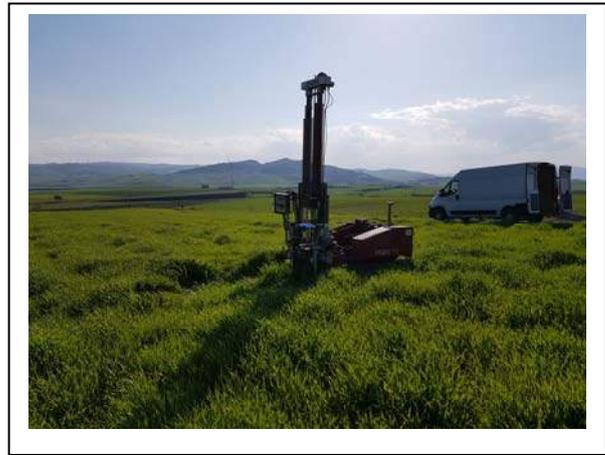
La prova, ubicata ca. 400 metri a W della prova n.4, è stata portata fino alla profondità di 10.40 metri. Di seguito la diagrafia risultante dalla prova.
