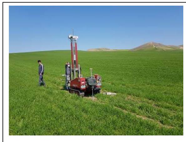
La prova, ubicata a ca. 250 metri a SW dalla precedente, è stata portata fino alla profondità di 8.40 metri, verificando il progressivo costante incremento del grado di consistenza. Di seguito la diagrafia risultante dalla prova.
