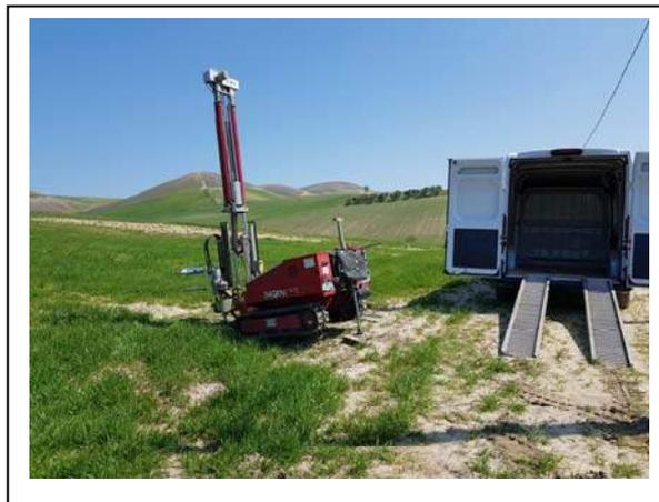
La prova DPSH2, ubicata ad una distanza di ca. 250 metri a NW dalla precedente, è stata portata fino alla profondità di 6.40 metri, verificando il progressivo costante incremento del grado di consistenza; di seguito la diagrafia risultante dalla prova.
