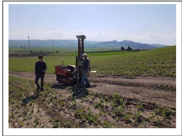
La prova, ubicata ca. al centro tra le prove n. 5 e 6, è stata approfondita fino alla profondità di 8 metri. Di seguito la diagrafia risultante dalla prova.
