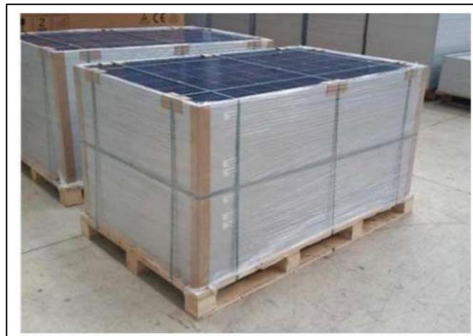
*Figura 6: Impilamento e reggiatura dei pannelli fotovoltaici*
