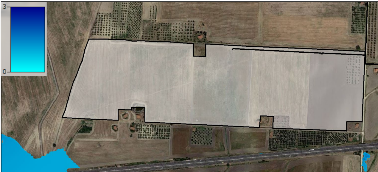
Figura 16: Interferenza C.01 in riferimento ai massimi tiranti idrici stimati nelle aree inondabili relative ad eventi con tempi di ritorno pari a 200 anni e in condizione post-operam su base Google Satellite
