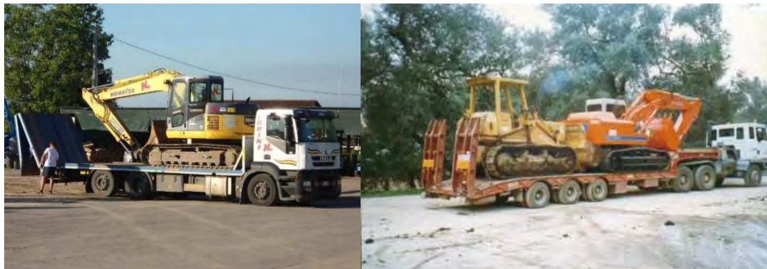
Figura 1: esempi di trasporto su gomma ribassati per mezzi d'opera
