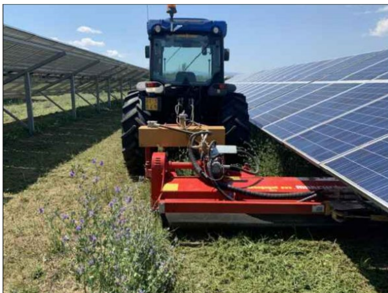
Figura 8 Trinciatura del cotico erboso con barra falciante
