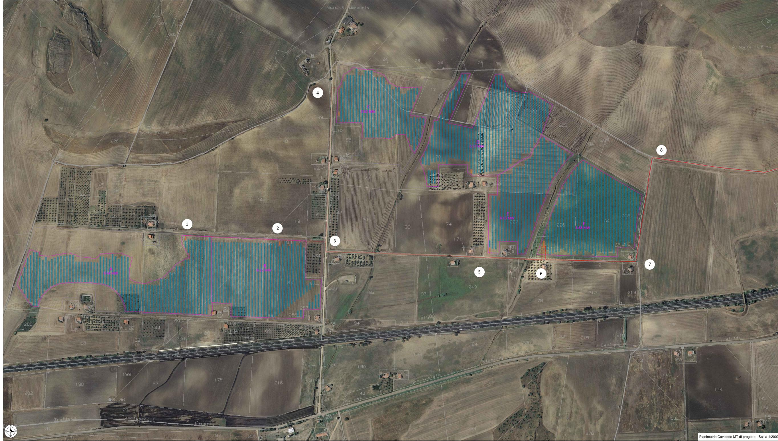
Planimetria Cavidotto MT di progetto - Scala 1:2000
