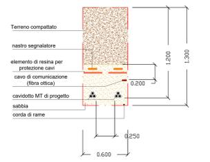
Particolare della sezione trasversale - Scala 1:20
