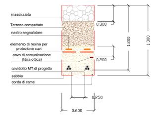
Particolare della sezione trasversale - Scala 1:20
