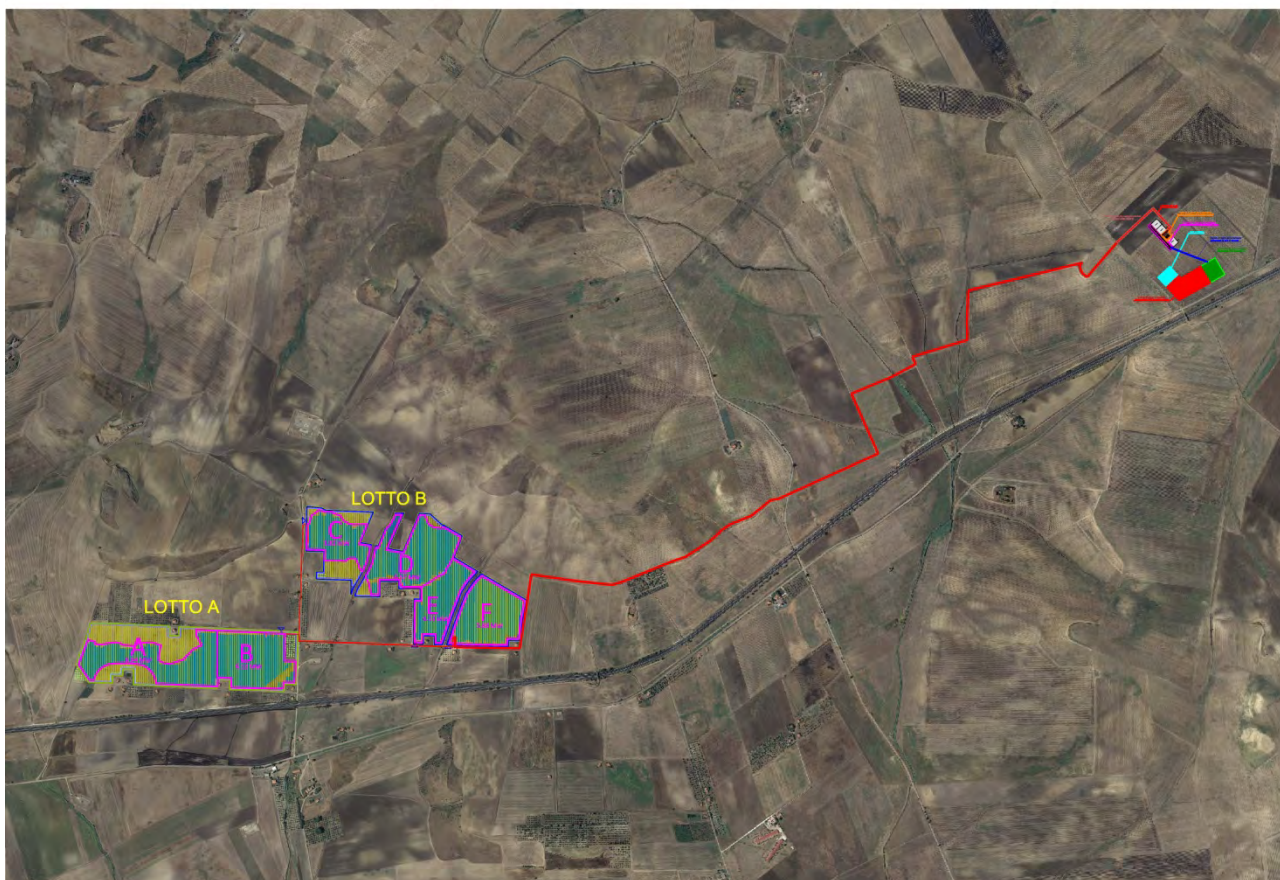
Figura 13 – Il contesto paesaggistico in cui è inserito l'intero progetto, con indicazione del cavidotto interrato
