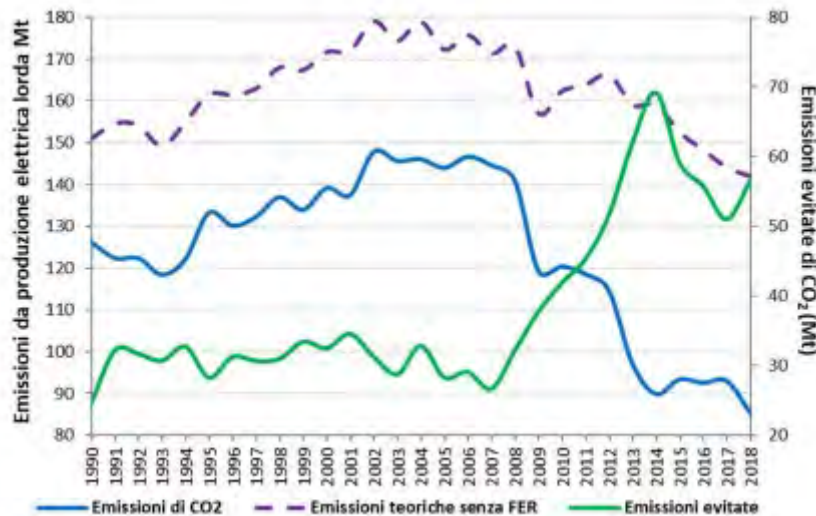
Figura 13 - Andamento delle emissioni effettive per la produzione lorda di energia elettrica e delle emissioni teoriche per la produzione di energia elettrica da fonti rinnovabili con equivalente produzione da fonti fossili.
