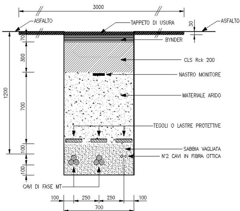
**Figura 4:** *Tipici di posa cavi MT con n°2 linee su viabilità asfaltata*
