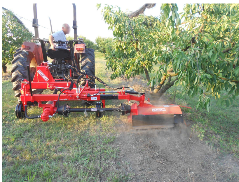
Figura 6.1: Esempio di fresatrice interceppo per le lavorazioni sulla fila (Foto: Cucchi Macchine Agricole)
