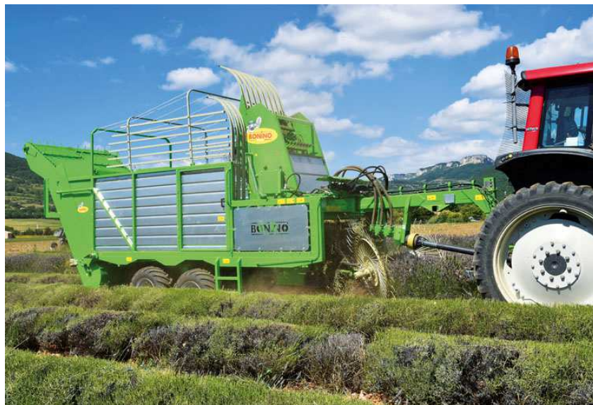
Figura 6.5: Raccogliitrice meccanica di lavanda trainata e relative specifiche tecniche (Foto: Bonino S.a.s.)
