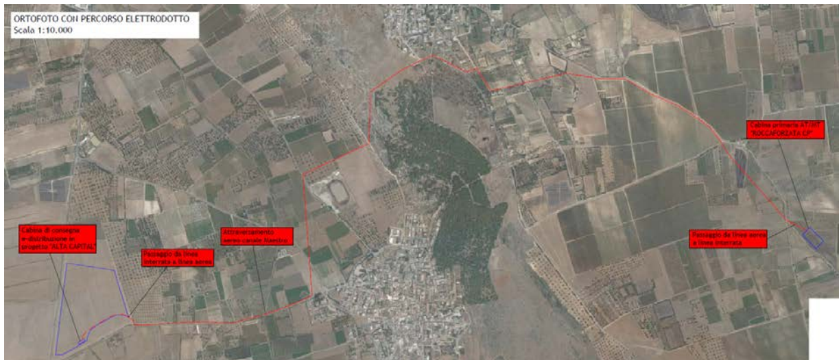
Figura 4.13 Ortofoto riportante il percorso dell'elettrodotto
