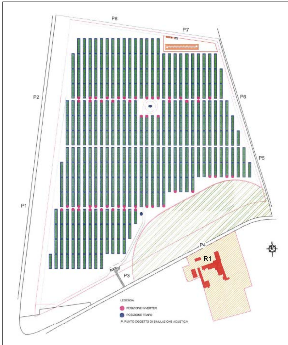
Figura 8.2 Planimetria con indicazione dei punti oggetto di monitoraggio fonometrico a seguito della messa in esercizio dell'impianto
