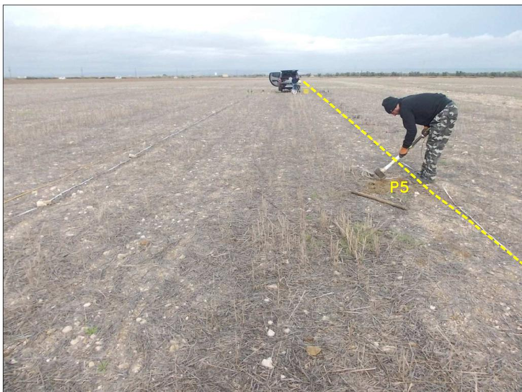
Foto 4: Postazione ed allineamento del Profilo Sismico MASW.1
