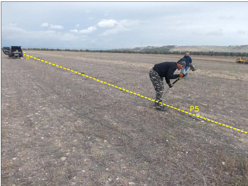
Foto 3: Postazione ed allineamento del Profilo Sismico MASW.1
