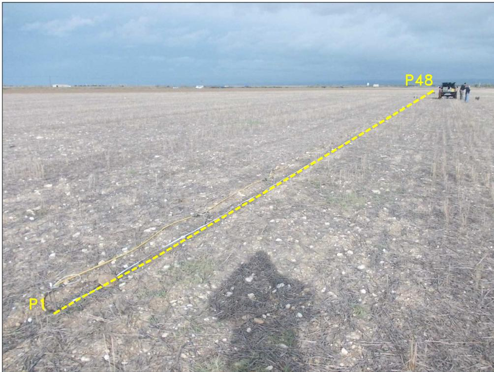
Foto 7: Postazione ed allineamento della Tomografia Elettrica T.E.1
