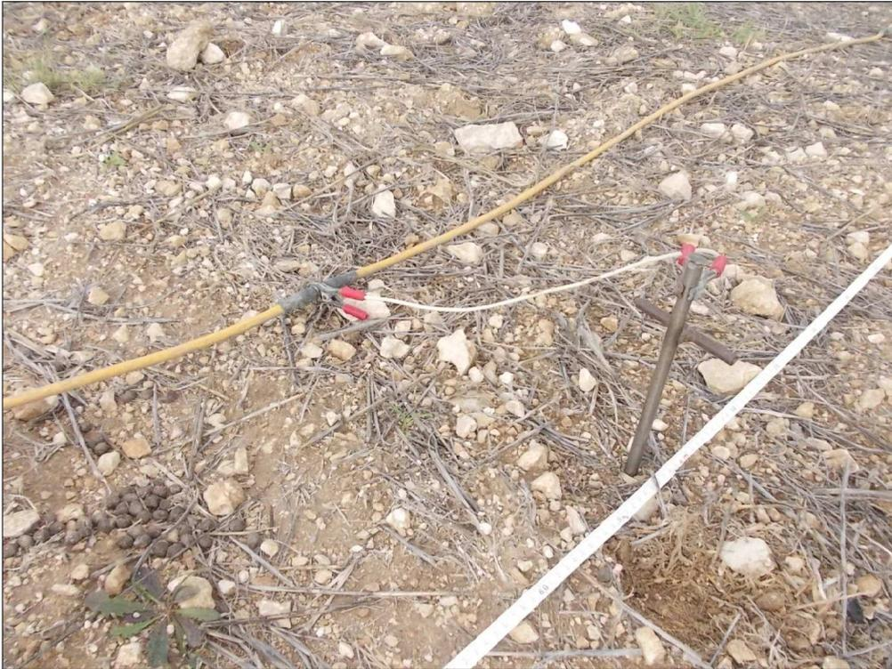
Foto 9: Postazione ed allineamento della Tomografia Elettrica T.E.1
