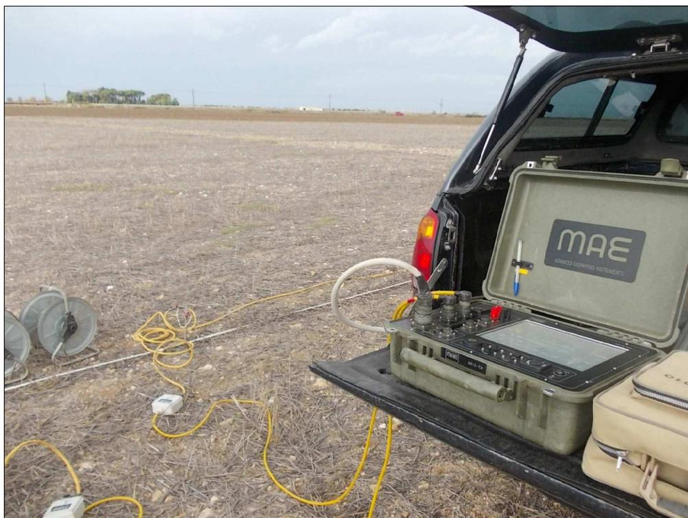
Foto 10: Postazione ed allineamento della Tomografia Elettrica T.E.1
